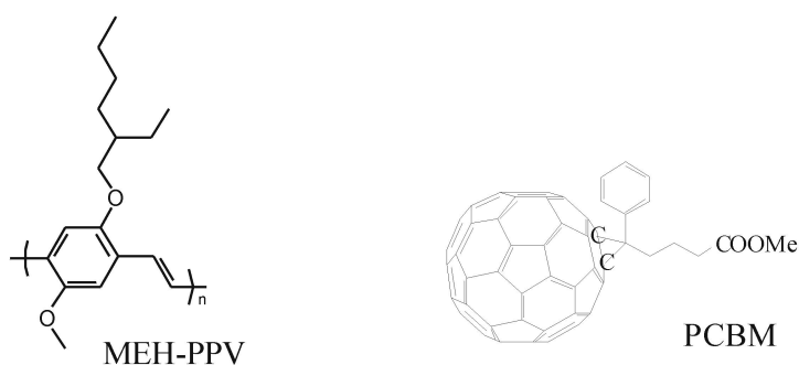
FIG. 4.1 – Structure chimique des molécules MEH-PPV et PCBM.
