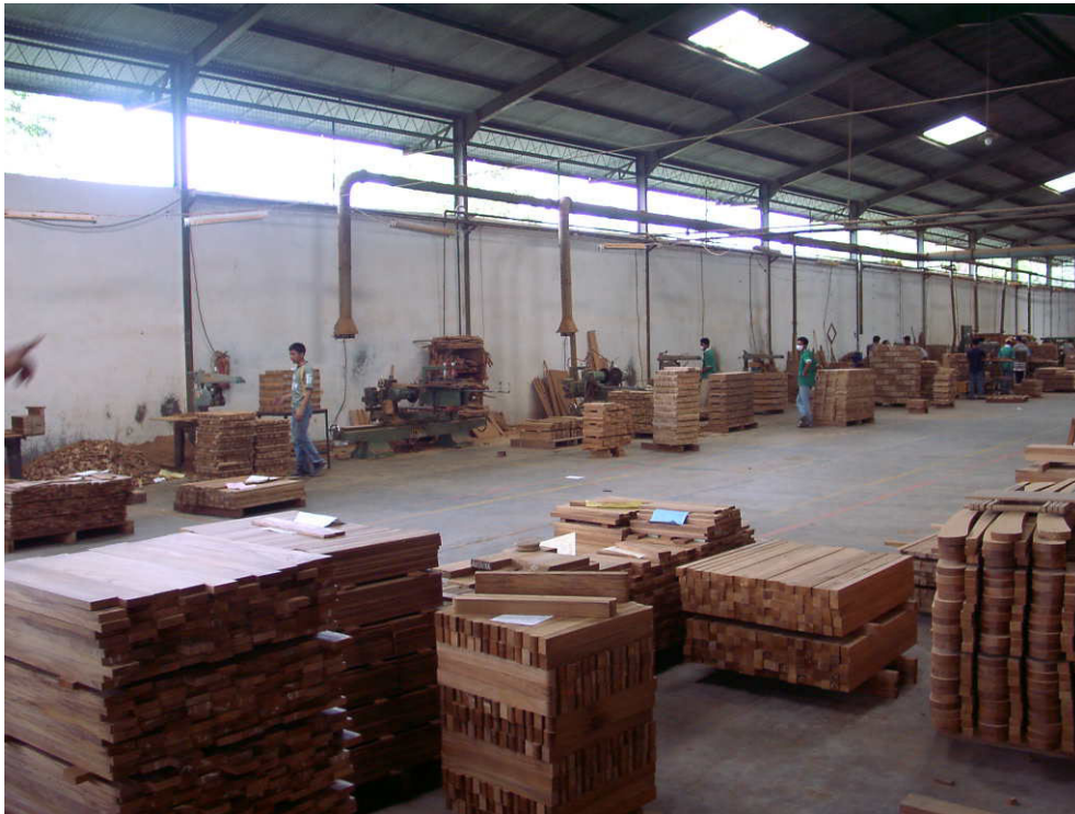
Fig. 29 : Alignement des postes de transformation pour les différentes pièces de la fabrication de meubles en teck, dans une usine Indonésienne, produisant entre autres pour les magasins français « Habitat » (Photo JM Roda)
