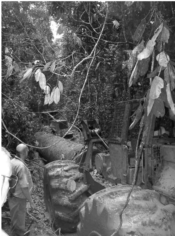
Fig. 20 : Débardage d’une grume par une machine de débardage - débusquage, dans la province de l’Equateur, RDC (Photo JM Roda)
