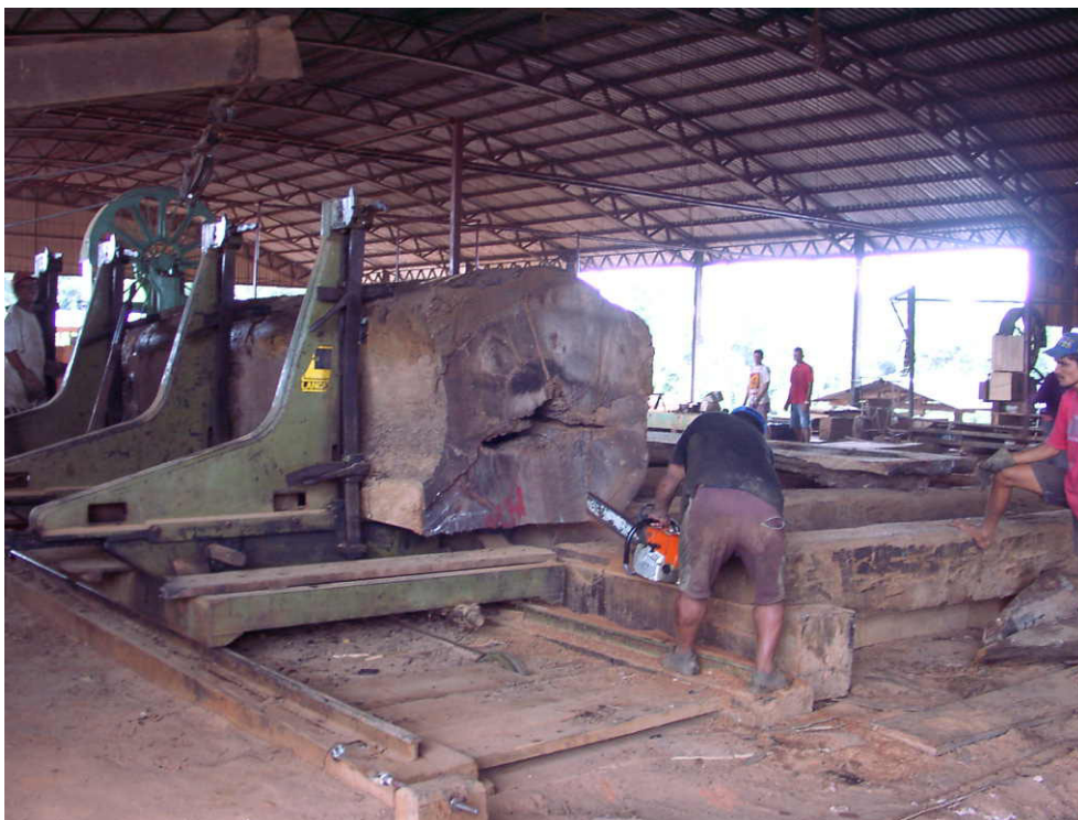
Fig. 25 : Préparation à la tronçonneuse d'une grume sur le chariot de scie de tête, avant transformation, dans l'Etat de l'Acre, Brésil (Photo JM Roda)
