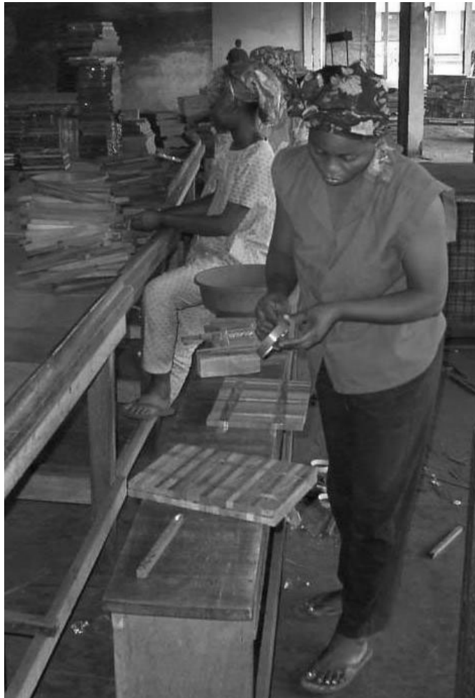
Fig. 58 : Récupération des petites chutes de bois pour les assembler en pièces de parquet « mosaïque », avec assemblage temporaire au ruban adhésif dans une entreprise Italienne en RDC (Photo JM Roda)
