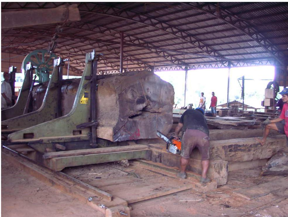
Fig. 25 : Préparation à la tronçonneuse d’une grume sur le chariot de scie de tête, avant transformation, dans l’Etat de l’Acre, Brésil (Photo JM Roda)
