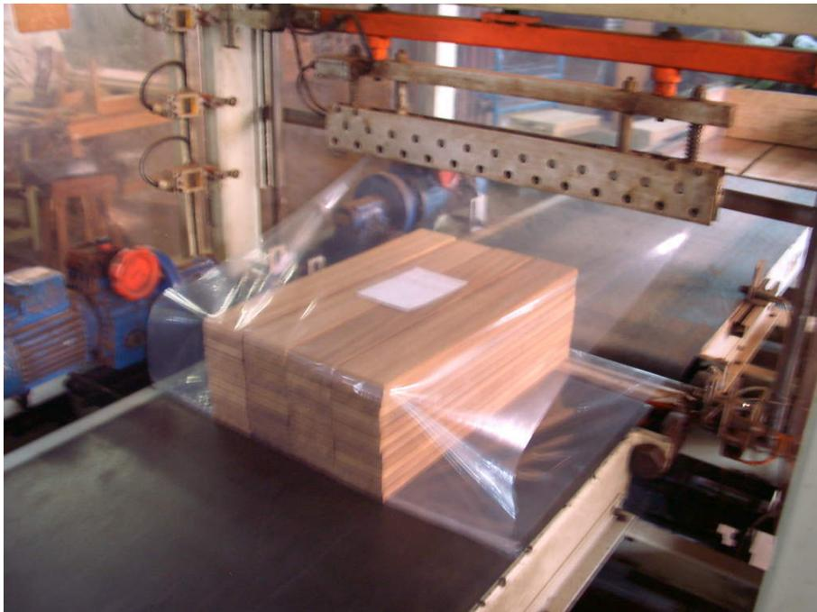
Fig. 59 : Emballage sous film plastique d'un lot de pré-débits de parquet massif, dans une entreprise Italienne en RDC (Photo JM Roda)
