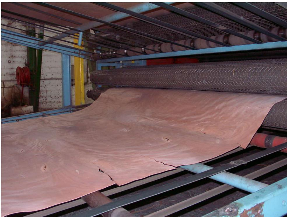
Fig. 28 : Feuille d’Okoumé à la sortie du séchoir, à Libreville, Gabon (Photo JM Roda)
