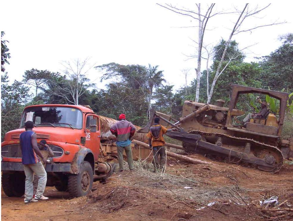
Fig. 22 : Chargement d’un grumier par bulldozer faisant glisser les grumes sur une rampe, dans la province du Bas-Congo, RDC (Photo JM Roda)
