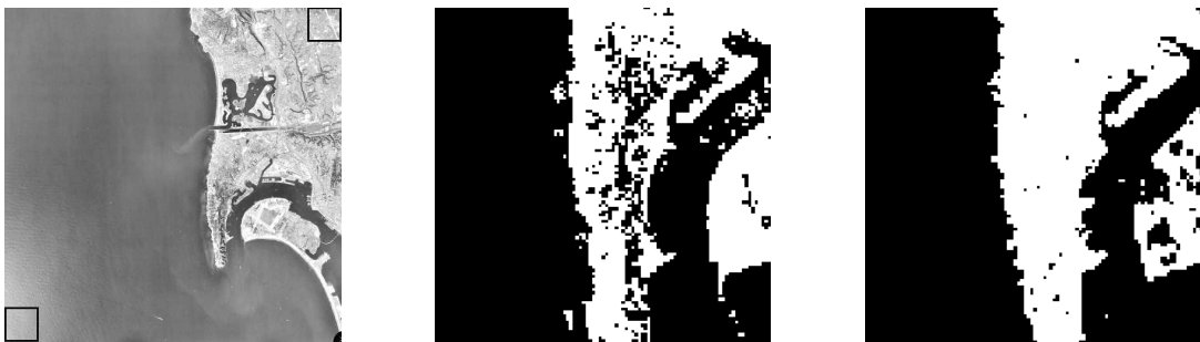
FIG. 10.10 – a) San Diego : image originale de 1024 \times 1024 utilisée pour la phase d'apprentissage des deux textures (océan et terre), matérialisée par deux sous-images carrées de taille 100 \times 100 . b) Résultat d'une segmentation binaire brute au niveau pixel sur une sous-image de taille 256 \times 256 . c) Résultat de la segmentation binaire par fusion inter-échelles.
