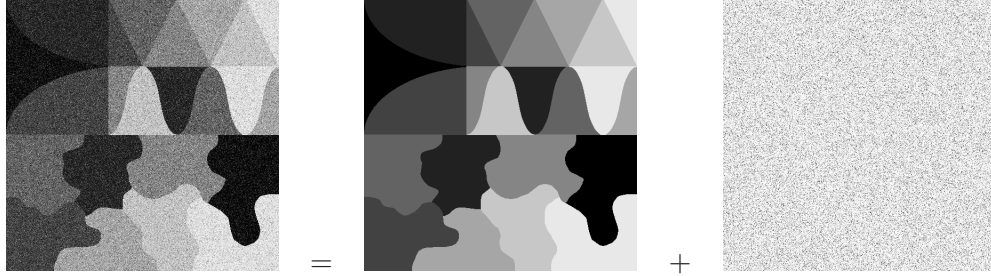
FIG. 7.1 – a) Image observée g b) image originale f c) bruit \epsilon
