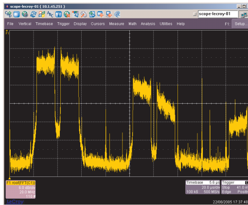
FIG. 6.23 : Capture Fréquentielle du signal MC-CDMA en seconde fréquence intermédiaire avec l'option de zero-stuffing, l'échelle fréquentielle étant de 20\text{ MHz/div}
