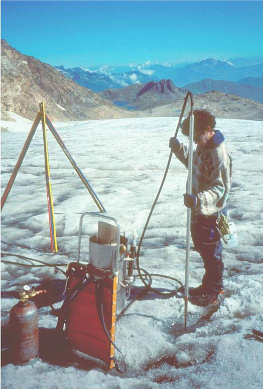
FIG. 1.5 – Implantation de balises d’ablation grâce à la sonde à vapeur, sur le glacier de St Sorlin. Le train de perches d’ablation qui va être inséré dans le trou se trouve à l’arrière plan. Photo LGGE.
