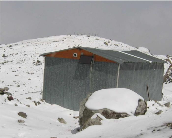
FIG. 2.7 – L'appareil photographique automatique installé dans la cabane de St Sorlin, avec le système d'alimentation (panneau solaire), fin août 2004, après une chute de neige. Sur la colline à l'arrière plan, on distingue les prémices de la future station météorologique. Photo Martin Gerbaux.
