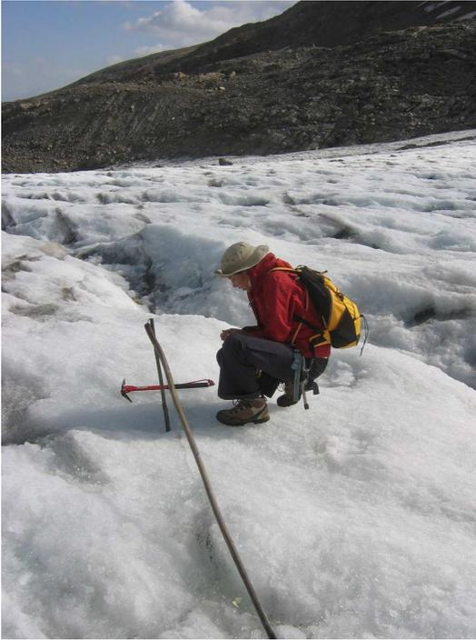
FIG. 1.6 – Mesure de l'émergence d'une balise sur le glacier de St Sorlin, octobre 2004, par une charmante opératrice. Remarquez l'irrégularité de la surface autour de la balise et, plus largement à grande échelle, dans la zone de mesure (bédières, crevasses...), source significative d'incertitude. Photo Martin Gerbaux
