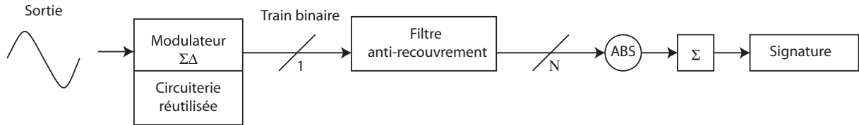
FIG. 2.15 – Méthode d'analyse basée sur l'utilisation d'une signature obtenue par modulation \Sigma\Delta
