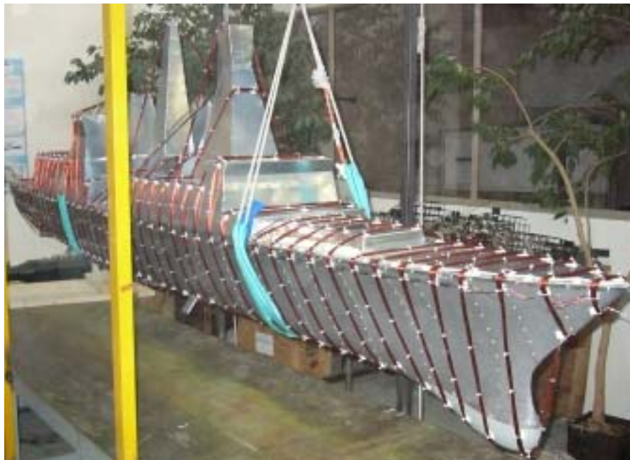
Figure 1.4 : Boucles de traitement sur la maquette Fincantieri (avec l'aimable autorisation des chantiers navals Fincantieri)
