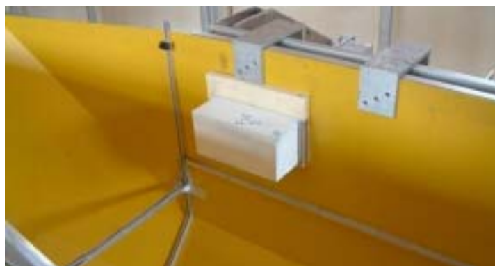
Figure 4.32 : Masse interne n°1 placée sur la coque
