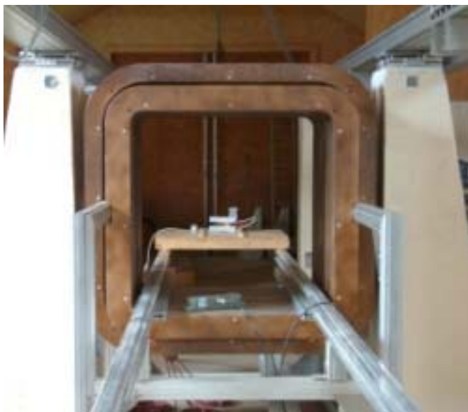
Figure 4.27 : Four permettant le traitement magnétique d'objets quelconques
