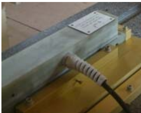
Figure 4.2 : Gradientmètre de type fluxgate
