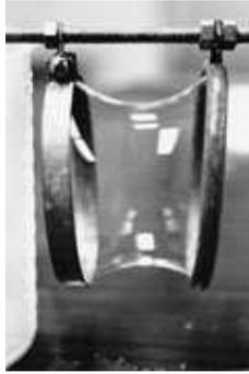
**Figure IV.11:** Film de savon tendu entre deux anneaux métalliques. La forme du film minimise la surface en adoptant la forme d'une caténoïde. Image extraite du site [www.21stcenturysciencetech.com/](http://www.21stcenturysciencetech.com/)
