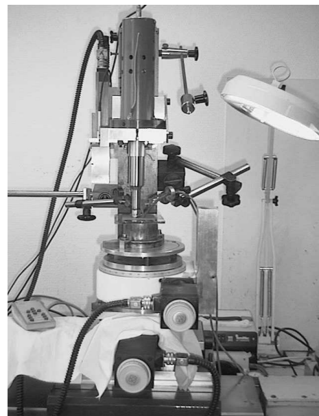
FIG. 10.1 – Répartition de l'amplitude du mouvement dans l'ensemble vibrant transducteur-amplificateurs (convertisseurs)-sonotrode, d'après [89], et photo de l'appareil.
