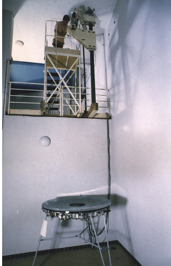
Figure 47 : Vue du miroir actif de 1.5 m lors des premiers tests optiques. Une lentille de Offner et un analyseur de surface d'onde sont placés près du centre de courbure, 5.15 m au-dessus du miroir.
