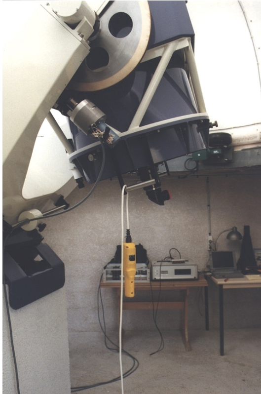
Figure 14 : Télescope VALMECA sur lequel notre entraînement a été testé. Le moteur de déclinaison est visible en premier plan près de la fourche. Au fond, sont visibles, un PC portable, le contrôleur de télescope et un driver micro-pas SLO-SYN. L'ensemble permet de contrôler l'entraînement et le pointage rapide ( 2^\circ/s ) du télescope.
