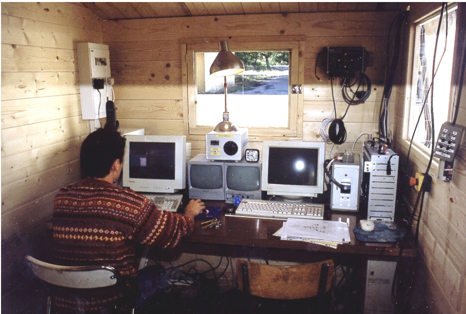
Figure 68 : Intérieur de la « station de pilotage » abritant l'électronique et les deux PC contrôlant l'ensemble du télescope.
