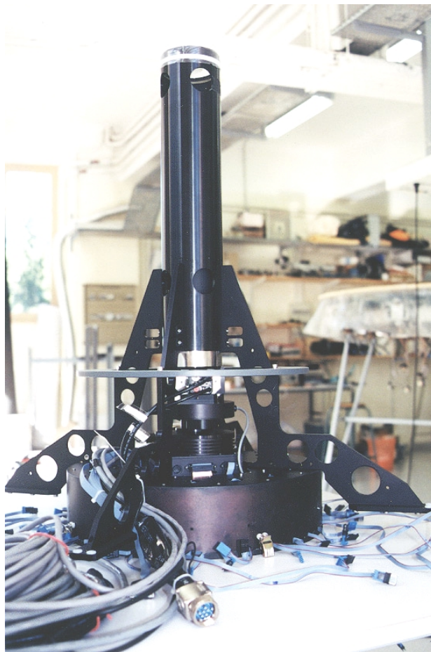
Figure 64 : Photographie du bloc caméra du télescope OVLA avant l'application de son enveloppe isolante, empêchant l'électronique de chauffer le miroir actif. L'ensemble sera ensuite accroché au barillet actif, dans le trou central du miroir, grâce aux 4 pattes de fixation disposées à 90°.
