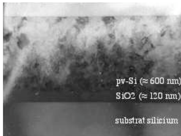
a) structure granulaire aléatoire obtenue par cristallisation "volumique"
