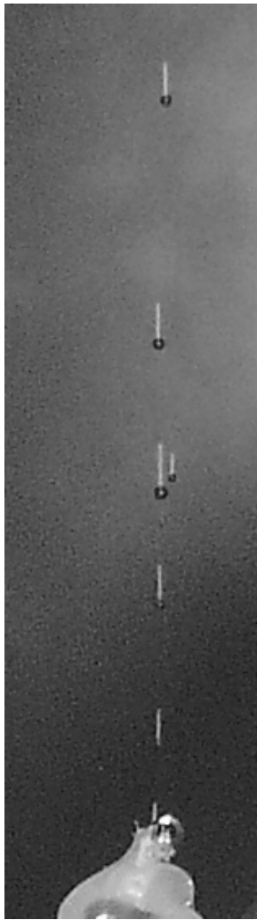
FIG. 2.2 – Ascension de quelques bulles issues de l'extrémité d'un fil de platine, relié à un générateur de tension continue. La photographie ci-contre a été prise en synchronisation lente au 50ème de seconde avec un éclairage externe continu. Les vitesses d'ascension mesurées sur plusieurs bulles à partir de photos semblables sont reportées sur le graphe ci-dessus. Le coefficient directeur \alpha de la droite ajustée aux données expérimentales est de 0,21 \text{ mm/s}/\mu\text{m} . La vitesse d'ascension donnée par la loi de Stokes est ici représentée en noir à titre indicatif.
