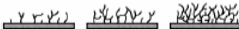
Figure 19: Représentation schématique des chaînes de polymère en croissance lors d'une réaction de greffage photoinduit et dont le temps d'irradiation augmente de la gauche vers la droite [102].
