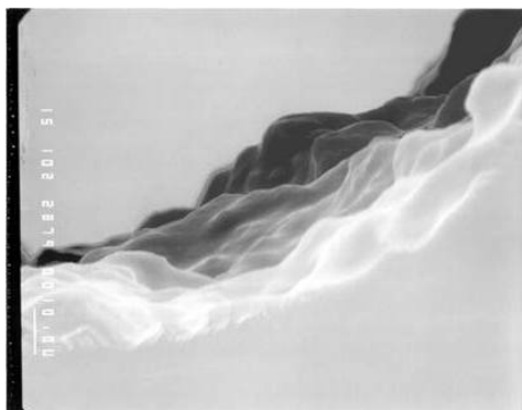
Figure 3 : Image MEB d'un capillaire de silice dont la surface interne a été greffée par une phase stationnaire de type sol-gel.
