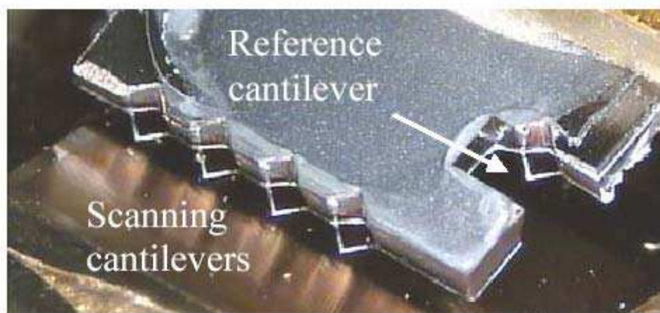
Fig. 27 : Peigne de microleviers piézorésistifs
