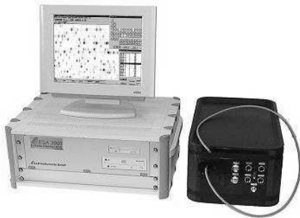
Photographie 9 : Spectromètre à échelle ESA 3000.
