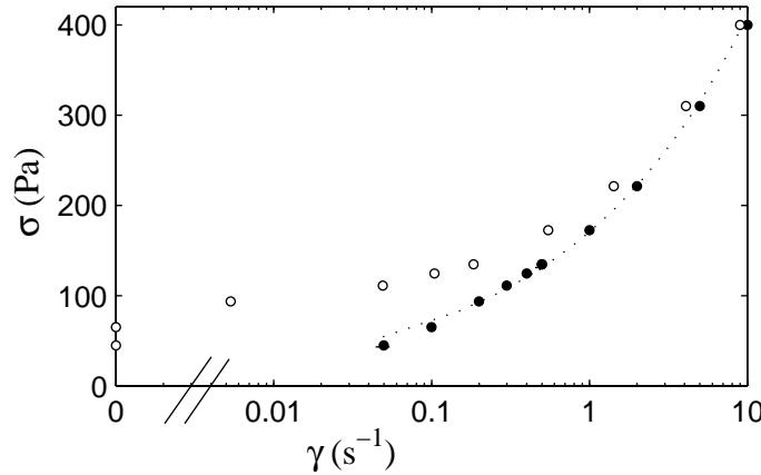
FIG. 4.8 – Courbe d'écoulement  $\sigma = f(\dot{\gamma})$  (●) obtenue en moyennant les réponses temporelles de la contrainte  $\sigma(t)$  sur les 100 dernières secondes de chaque palier. La ligne en pointillés est le meilleur ajustement obtenu pour une loi de puissance  $\sigma = A\dot{\gamma}^n$  avec  $A = 171 \text{ Pa}\cdot\text{s}^{0,38}$  et  $n = 0,38$ . Les symboles vides (○) correspondent aux données rhéologiques corrigées du glissement.
