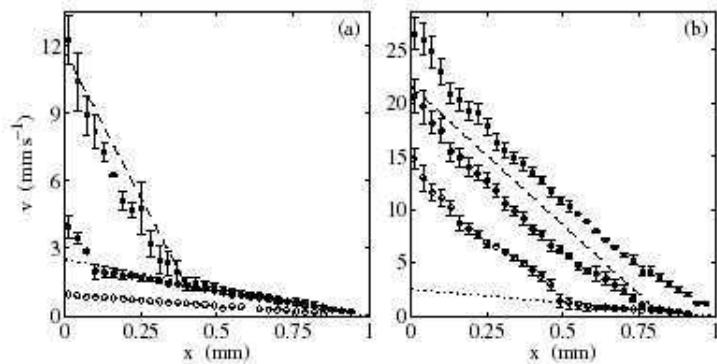
FIG. 1.7 – Profils de vitesse mesurés par DLS en mode hétérodyne à différents taux de cisaillement imposés dans une solution semi-diluée CpCl/NaSal/NaCl. La figure est extraite de la référence [99].
