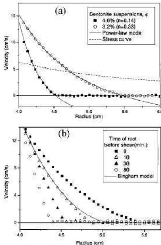
FIG. 1.8 – Profils de vitesse enregistrés dans des suspensions de Bentonite, par vélocimétrie NMR. (a) Profils de vitesse enregistrés pour deux fractions volumiques  $\phi = 3,2$  et 4 %. (b) Profils de vitesse enregistrés après des temps de repos avant démarrage de l’expérience variables. Ces profils mettent en évidence la coexistence entre une zone à vitesse nulle et une bande cisaillée. La figure est extraite de la référence [33].
