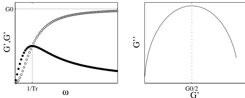
FIG. 1.4 – Comportement en rhéologie linéaire d'un fluide de Maxwell. La figure de gauche est une représentation des modules de conservation  $G'$  et de perte  $G''$  en fonction de la fréquence  $\omega$ . La représentation Cole-Cole  $G'' = f(G')$  correspondante est donnée sur la figure de droite.
