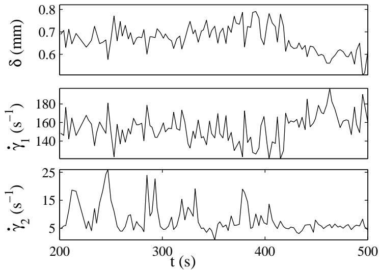
FIG. 3.26 – Fluctuations (a) de la position de l'interface  $\delta(t)$  (b) du cisaillement dans la bande fortement cisaiillée  $\dot{\gamma}_h(t)$  (c) et du cisaillement dans la bande faiblement cisaiillée  $\dot{\gamma}_l(t)$  à  $\dot{\gamma} = 93 \text{ s}^{-1}$ .
