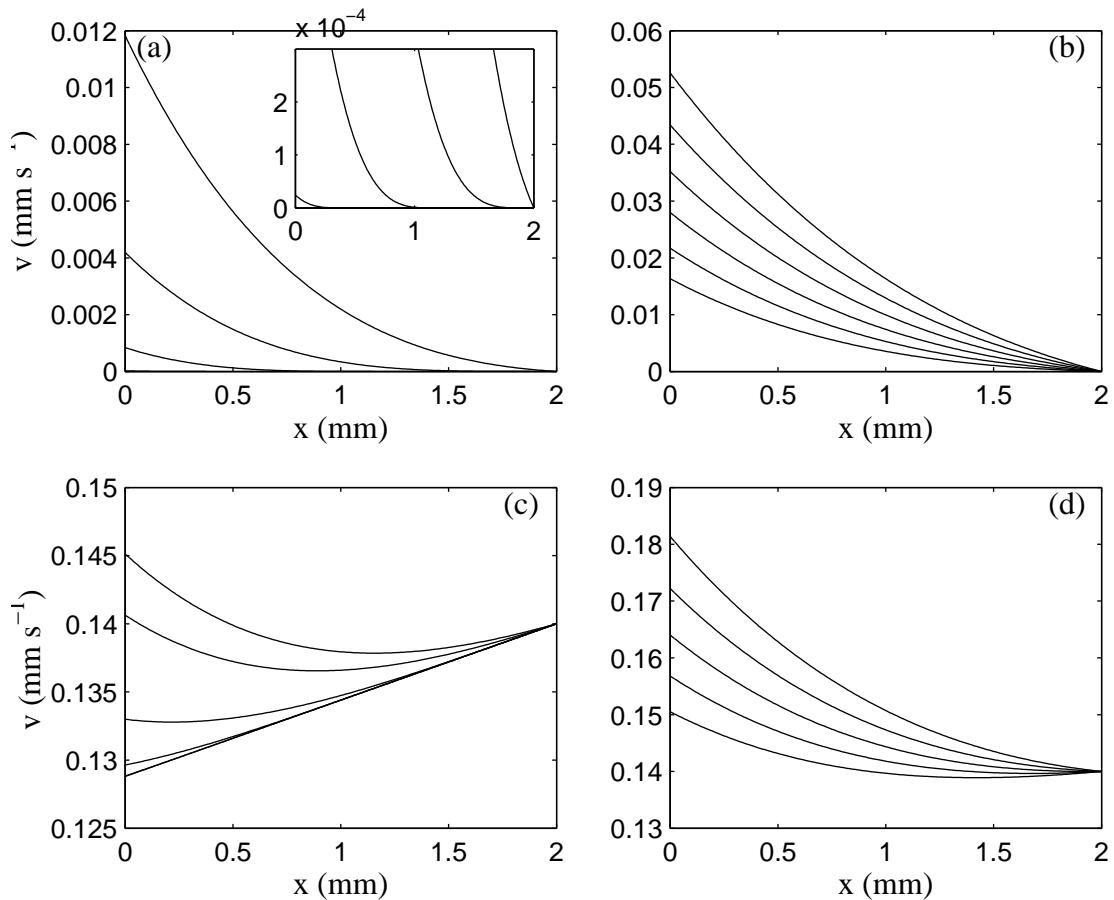
FIG. 4.13 – Profils de vitesse théoriques sans glissement aux parois pour  $\sigma =$  (a) 75, 80, 85 et 90 Pa (b) 92, 94, 96, 98, 100 et 102 Pa ; profils de vitesse théoriques calculés en présence de glissement aux parois ( $v_2 = 0, 14 \text{ mm s}^{-1}$ ) pour  $\sigma =$  (c) 75, 80, 85, 90 et 92 Pa (d) 94, 96, 98, 100 et 102 Pa.
