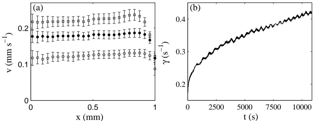
FIG. 4.32 – Évolution de l'écoulement après un saut de contrainte de 0 à 60 Pa dans l'émulsion formulée avec 8 % de SDS. (a) Profils de vitesse moyennés sur les intervalles  $t = 0\text{--}700 \text{ s}$  ( $\circ$ ),  $t = 3000\text{--}6000 \text{ s}$  ( $\bullet$ ) et  $t = 11000\text{--}13000 \text{ s}$  ( $\square$ ). (b) Réponse rhéologique du cisaillement  $\dot{\gamma}(t)$  enregistrée simultanément aux profils de vitesse.
