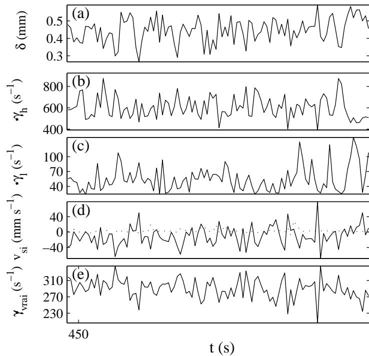
FIG. 3.35 – Fluctuations (a) de la position de l’interface  $\delta(t)$ , (b) du cisaillement dans la bande fortement cisaillée  $\dot{\gamma}_h(t)$ , (c) du cisaillement dans la bande faiblement cisaillée  $\dot{\gamma}_l(t)$ , (d) des vitesses de glissement au rotor (trait plein) et au stator (pointillés), (e) du cisaillement « vrai »  $\dot{\gamma}_{vrai}(t)$  après un saut de cisaillement de  $\dot{\gamma} = 0$  à  $289\ s^{-1}$ .
