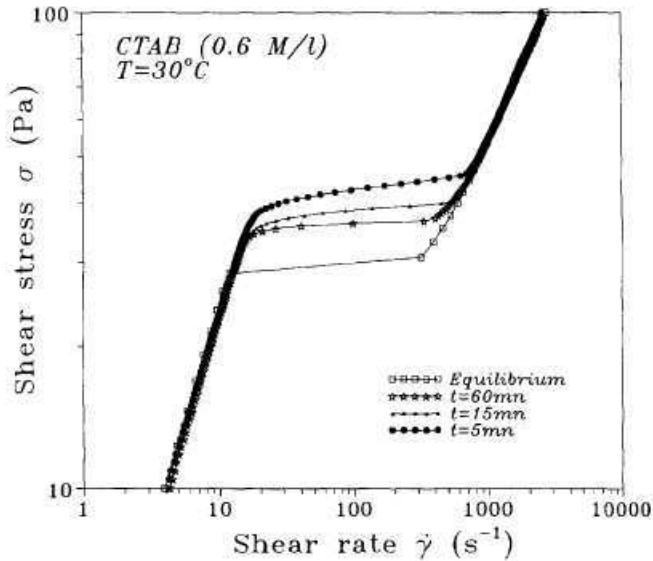
FIG. 3.5 – Courbes d’écoulement enregistrées dans une solution de CTAB/H<sub>2</sub>O concentrée à 0,6 M (soit environ 22 % en masse) pour différents temps de balayage. La figure est tirée de la référence [27].
