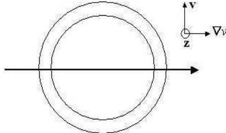
FIG. 2.14 – Représentation schématique de la géométrie radiale utilisée pour enregistrer les spectres RX.
