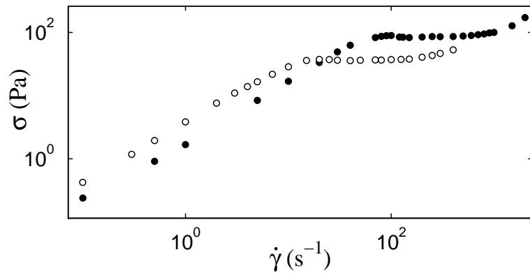
FIG. 3.69 – Courbes d'écoulement enregistrées à  $T = 41^\circ\text{C}$  (○) et  $T = 44^\circ\text{C}$  (●).
