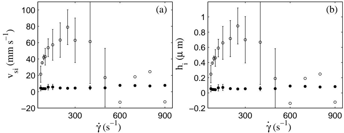
FIG. 3.43 – Glissement aux parois à  $T = 44^\circ\text{C}$ . (a) Vitesses de glissement au rotor  $v_{s1}$  (○) et au stator  $v_{s2}$  (●) en fonction du cisaillement  $\dot{\gamma}$ . (b) Épaisseur des films de lubrification au rotor  $h_1$  (○) et au stator  $h_2$  (●) en fonction du cisaillement  $\dot{\gamma}$ .
