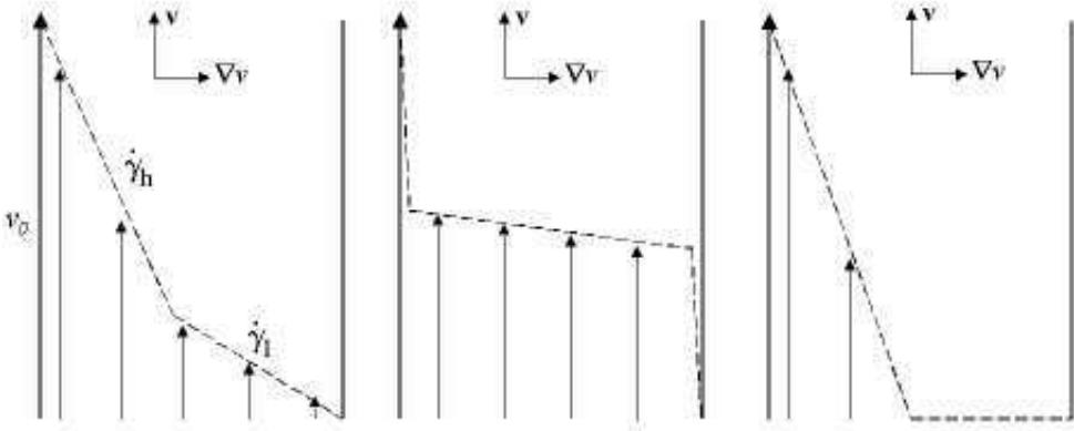
FIG. 1.6 – Exemples d'éoulements inhomogènes dans un écoulement de cisaillement. (a) « Shear-banding » : coexistence de bandes de cisaillement différents  $\dot{\gamma}_h$  et  $\dot{\gamma}_l$ . (b) Glissement apparent lié à l'existence de couches de lubrification près des parois. (c) Transition « pâte-fluide » : coexistence d'une bande « fluide » cisaillée et d'une zone non cisaillée au voisinage d'une contrainte seuil.
