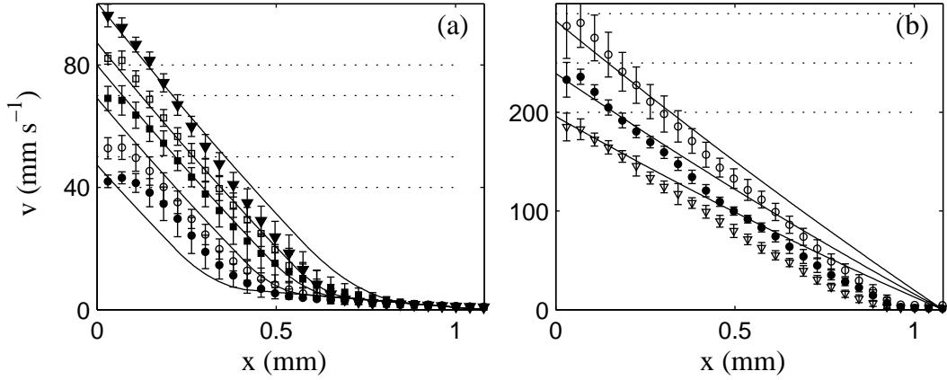
FIG. 3.19 – Ajustement des profils expérimentaux  $\langle v(x) \rangle$  par les profils théoriques donnés par les équations 3.4.1 et 3.4.1 (lignes en trait plein) pour  $\sigma^* = 34,8 \text{ Pa}$ . Les cisaillements appliqués sont (a) 38 ( $\bullet$ ), 47 ( $\circ$ ), 66 ( $\blacksquare$ ) et  $76 \text{ s}^{-1}$  ( $\square$ ) (b) 95 ( $\bullet$ ), 189 ( $\circ$ ), 236 ( $\blacksquare$ ) et  $284 \text{ s}^{-1}$  ( $\square$ ). Les pointillés indiquent la vitesse du rotor.
