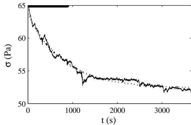
FIG. 3.29 – Réponse temporelle  $\sigma(t)$  enregistrée à  $T = 41^\circ\text{C}$  après un saut de cisaillement de 0 à  $\dot{\gamma} = 77 \text{ s}^{-1}$ . Le trait épais indique l'intervalle de temps pendant lequel les profils de vitesse sont enregistrés. La courbe en pointillés est l'ajustement exponentiel de la relaxation donné par l'équation 3.21 avec  $\sigma_\infty = 52,4$ ,  $\sigma_M = 63,7$  et  $\tau_e = 800 \text{ s}$ .
