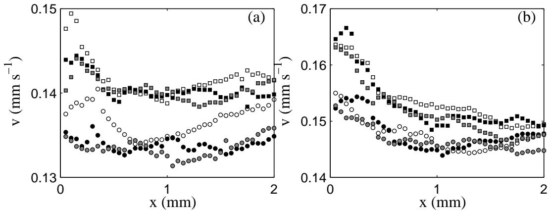
FIG. 4.15 – Profils de vitesse enregistrés à (a)  $\sigma = 90$  Pa ( $\circ$ ),  $\sigma = 92$  Pa ( $\square$ ), (b)  $\sigma = 94$  Pa ( $\circ$ ) et  $\sigma = 96$  Pa ( $\square$ ). Pour chaque contrainte appliquée, trois profils de vitesse sont enregistrés successivement ; les trois teintes différentes des symboles permettent de les distinguer.
