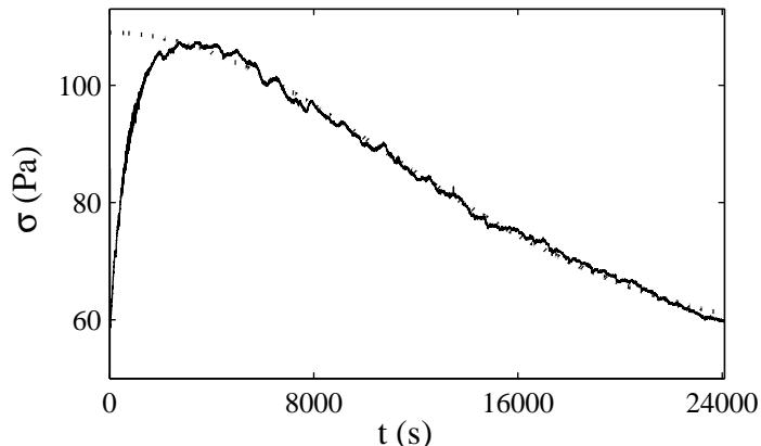
FIG. 3.50 – Réponse temporelle  $\sigma(t)$  enregistrée à  $T = 44^\circ\text{C}$  après un saut de cisaillement de 0 à  $\dot{\gamma} = 186 \text{ s}^{-1}$ . La courbe en pointillés est l'ajustement sigmoïdal de  $\sigma(t)$  donné par l'équation 3.24 avec  $\sigma_\infty = 56,4 \text{ Pa}$ ,  $\sigma_M = 109 \text{ Pa}$  et  $\tau_s = 15420 \text{ s}$ .
