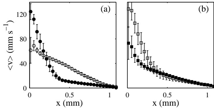
FIG. 3.52 – Dynamique lente après un saut de 0 à  $186\text{ s}^{-1}$  à  $T = 44^\circ\text{C}$ . Profils de vitesse  $\langle v(x) \rangle$  moyennés sur (a)  $t = 2\text{--}25$  ( $\bullet$ ),  $4400\text{--}4700$  ( $\circ$ ), (b)  $12000\text{--}12230$  ( $\blacksquare$ ), et  $23600\text{--}23840$  s ( $\square$ ). Les barres d'erreur sont les déviations standards des vitesses. La vitesse du rotor à  $\dot{\gamma} = 186\text{ s}^{-1}$  est  $v_0 = 200\text{ mm s}^{-1}$ .
