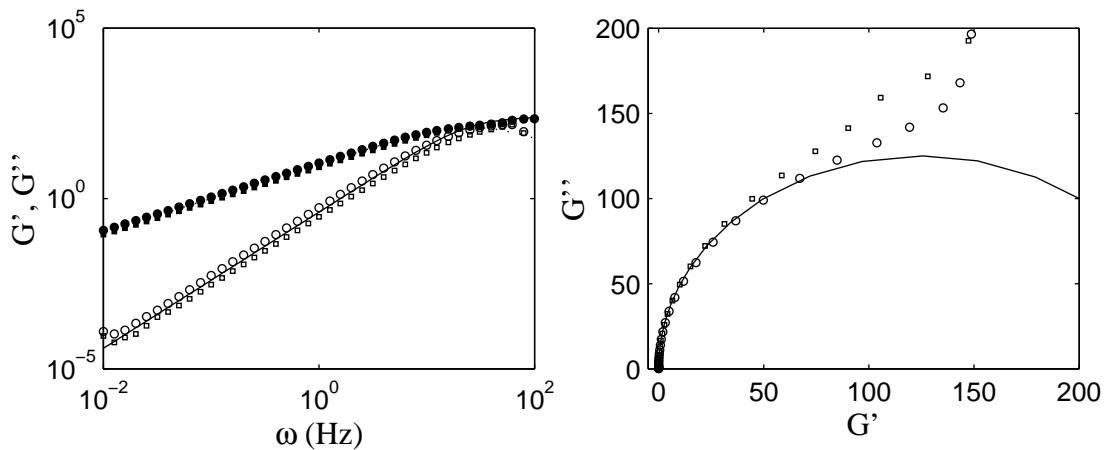
FIG. 3.4 – Rhéologie linéaire en balayage de fréquence ( $\omega = 0,01\text{--}100$  Hz) enregistrée dans la solution de micelles géantes avec ( $\circ$  et  $\bullet$ ) et sans diffuseurs ( $\square$  et  $\blacksquare$ ). (a) Modules de recouvrement  $G'$  (symboles vides) et de perte  $G''$  (symboles pleins) en fonction de la fréquence. (b) Représentation Cole-Cole du module de perte  $G''$  en fonction du module de recouvrement  $G'$ .
