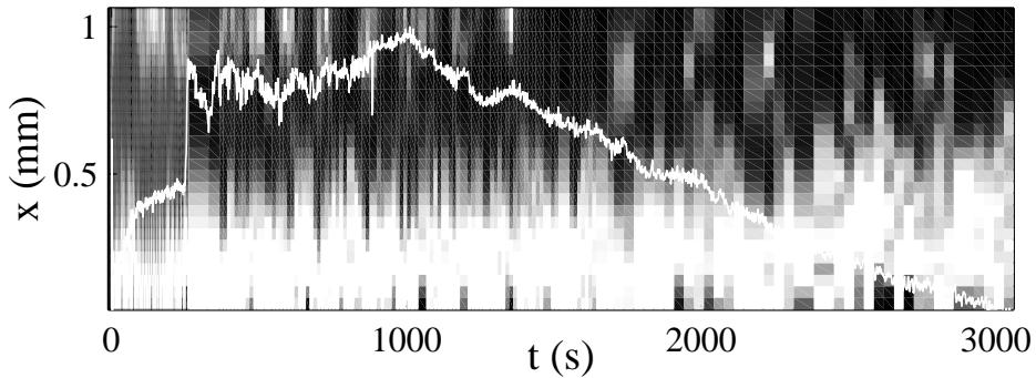
FIG. 3.33 – Diagramme spatio-temporel des cisaillements locaux  $\dot{\gamma}(x, t)$  après un saut de cisaillement de 0 à  $289 \text{ s}^{-1}$  à  $T = 41^\circ\text{C}$ . Une échelle de gris linéaire est utilisée pour coder les valeurs des cisaillements locaux : noir et blanc correspondent respectivement à  $\dot{\gamma} = 0 \text{ s}^{-1}$  et  $\dot{\gamma} \geq 500 \text{ s}^{-1}$ .
