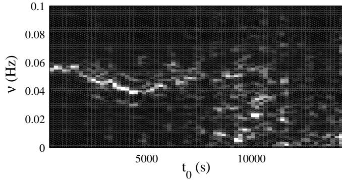
FIG. 3.61 – Diagramme temps-fréquence montrant le spectre de puissance  $P(\nu, t_0)$  de la position de l’interface  $\delta(t)$  calculé sur des fenêtres temporelles de largeur  $\Delta\tau = 742$  s et centrées autour de  $t_0$ .  $P(\nu, t_0)$  est normalisée par sa valeur maximale et codée linéairement en niveaux de gris entre 0 et 0.5.
