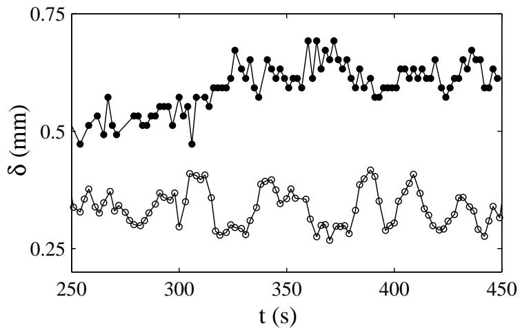
FIG. 3.67 – Fluctuations de la position de l'interface pendant l'enregistrement des courbes d'écoulement à  $T = 44^\circ\text{C}$ . Le cisaillement appliqué est  $\dot{\gamma} = 400 \text{ s}^{-1}$  et les données sont enregistrées dans des cellules de Couette sablée (●) et lisse (○).
