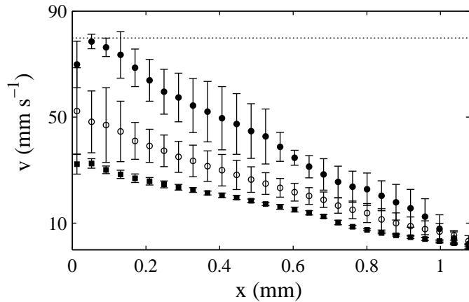
FIG. 3.30 – Profils de vitesse moyens  $\langle v(x) \rangle$  enregistrés après un saut de cisaillement de 0 à  $77 \text{ s}^{-1}$  à  $T = 41^\circ \text{C}$  et moyennés sur  $t = 3\text{--}20$  s (●),  $t = 40\text{--}51$  s (○) et  $t = 605\text{--}722$  s (■). La ligne en pointillés indique la vitesse du rotor  $v_0 = 79,9 \text{ mm s}^{-1}$ .
