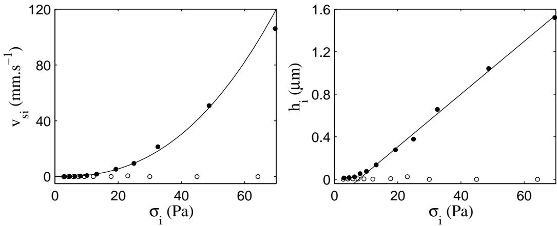
FIG. 3.13 – (a) Vitesses de glissement en fonction de la contrainte :  $v_{s1}$  en fonction de  $\sigma_1$  au rotor (●) et  $v_{s2}$  en fonction de  $\sigma_2$  au stator (○). Le trait plein est la loi  $v_{s1} = 3, 5 \cdot 10^{-3} \sigma_1^{2,45}$ . (b) Épaisseur des films de lubrification au rotor  $h_1$  (●) et au stator  $h_2$  (○).
