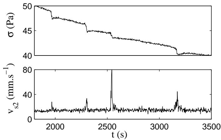
FIG. 3.60 – Corrélation entre l'écoulement local et la rhéologie globale après un saut de cisaillement de 0 à  $589 \text{ s}^{-1}$  à  $T = 45^\circ\text{C}$ . (a) Vitesse de glissement au stator  $v_{s2}(t)$  et (b) contrainte globale  $\sigma(t)$  pour  $t = 1800\text{--}3500 \text{ s}$ .
