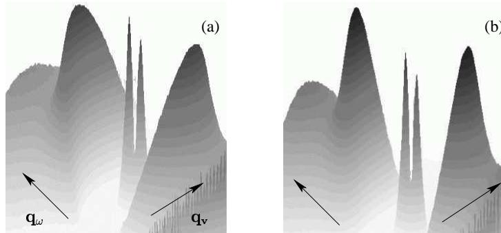
FIG. 3.14 – Spectres RX obtenus à  $T = 30^\circ\text{C}$  (a) au repos et (b) à  $\dot{\gamma} = 300 \text{ s}^{-1}$ . L'intensité de diffraction est enregistrée le long des axes réciproques ( $\mathbf{q}_v, \mathbf{q}_\omega$ ) pour des normes du vecteur d'onde diffracté  $\mathbf{q}$  comprises entre 0 et  $2 \text{ nm}^{-1}$ .
