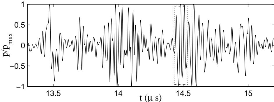
FIG. 2.5 – Signal de speckle ultrasonore typique enregistré dans une solution de latex synthétisés au laboratoire concentrée à 1% en masse. La tension enregistrée est normalisée par sa valeur maximale et on a  $V/V_{max} = p/p_{max}$ . Le rectangle en pointillés est la fenêtre temporelle considérée figures 2.6 et 2.7.
