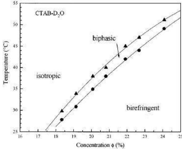
FIG. 3.3 – Diagramme de phase à l'équilibre du système CTAB/D<sub>2</sub>O tiré de la référence [96]. Lorsque l'on augmente la concentration en tensioactif, trois domaines sont identifiés : isotrope, biphasique (isotrope avec quelques zones biréfringentes) et biréfringent.
