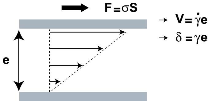
FIG. 1.2 – Principe d'une expérience de rhéologie. L'échantillon est confiné entre deux plaques de surface  $S$  et distantes de  $e$ . On applique une force constante  $F = \sigma S$  à la plaque supérieure. On peut alors mesurer le déplacement  $\delta$  de la plaque qui permet de définir la déformation du matériau  $\gamma = \delta/e$  et sa vitesse de déplacement  $V$  que l'on peut relier au taux de cisaillement dans le matériau  $\dot{\gamma} = V/e$ .
