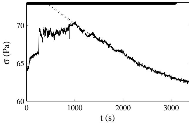
FIG. 3.32 – Réponse temporelle  $\sigma(t)$  enregistrée à  $T = 41^\circ\text{C}$  après un saut de cisaillement de 0 à  $\dot{\gamma} = 289\text{ s}^{-1}$ . Le trait épais indique l'intervalle de temps pendant lequel les profils de vitesse sont enregistrés. La courbe en pointillés est l'ajustement exponentiel de la relaxation donné par l'équation 3.21 avec  $\sigma_\infty = 53,5$ ,  $\sigma_M = 75,5$  et  $\tau_e = 3650\text{ s}$ .
