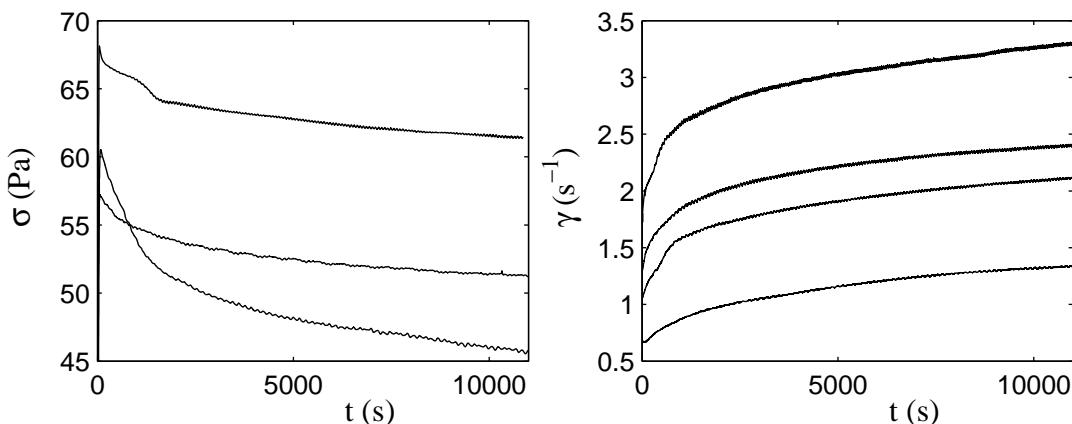
FIG. 4.37 – Réponses rhéologiques enregistrées après des sauts de contrainte et de cisaillement dans l’émulsion formulée avec 1 % de SDS. (a) Réponses temporelles de la contrainte après des sauts de cisaillement de (de bas en haut) 0 à 1  $s^{-1}$ , 1,5  $s^{-1}$  et 2  $s^{-1}$ .(b) Réponses temporelles du cisaillement après des sauts de contrainte de (de bas en haut) 0 à 50 Pa, 58 Pa, 60 Pa et 62 Pa.
