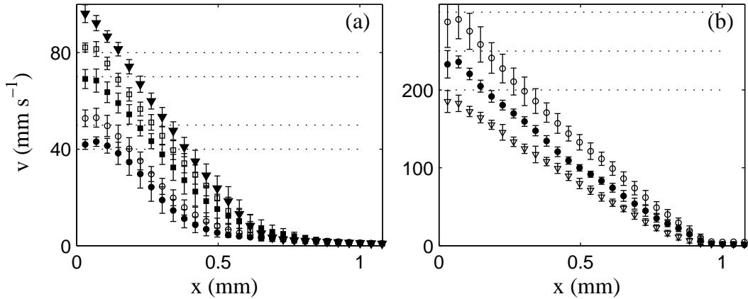
FIG. 3.17 – Moyennes temporelles des profils de vitesse  $\langle v(x) \rangle$  sur les 100 dernières secondes de chaque palier enregistrés à (a) 38 (●), 47 (○), 66 (■) et 76  $s^{-1}$  (□) (b) 95 (●), 189 (○) 236 (■) et 284  $s^{-1}$  (□). Les lignes en pointillés indiquent les vitesses du rotor pour chaque cisaillement appliqué.
