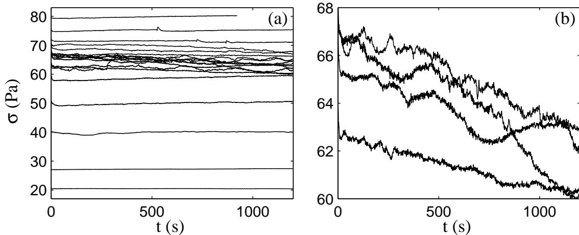
FIG. 3.62 – (a) Réponses temporelles  $\sigma(t)$  à  $T = 44^\circ\text{C}$  pendant l'enregistrement d'une courbe d'écoulement. (b) Zoom sur les réponses temporelles pour des cisaillements appliqués dans le plateau  $\dot{\gamma} = 60, 70, 80$  et  $200 \text{ s}^{-1}$ .
