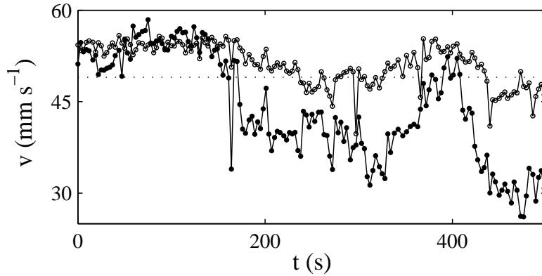
FIG. 3.23 – Évolution en fonction du temps des vitesses enregistrées aux abscisses  $x = 0$  mm (○) et  $x = 0,15$  mm (●) à  $\dot{\gamma} = 46$   $s^{-1}$ . La ligne en pointillés indique la vitesse du rotor  $v_0 = 49,9$   $mm\ s^{-1}$ .
