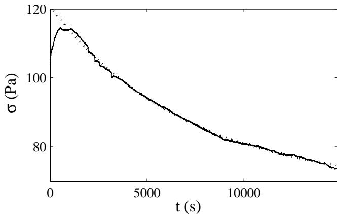
FIG. 3.55 – Réponse temporelle  $\sigma(t)$  enregistrée à  $T = 45^\circ\text{C}$  après un saut de cisaillement de 0 à  $\dot{\gamma} = 589 \text{ s}^{-1}$ . La courbe en pointillés est l'ajustement exponentiel de  $\sigma(t)$  donné par l'équation 3.21 avec  $\sigma_\infty = 68 \text{ Pa}$ ,  $\sigma_M = 121 \text{ Pa}$  et  $\tau_e = 7112 \text{ s}$ .
