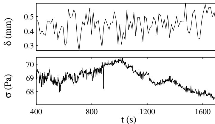
FIG. 3.36 – Fluctuations de la position de l'interface  $\delta(t)$  et de la contrainte globale  $\sigma(t)$  après un saut de cisaillement de 0 à  $\dot{\gamma} = 289 \text{ s}^{-1}$  à  $T = 41^\circ\text{C}$ .
