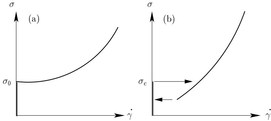
FIG. 4.4 – Représentation schématique des différentes lois rhéologiques décrivant le comportement des émulsions concentrées. (a) Loi de Herschel-Bulkley  $\sigma = \sigma_0 + \eta\dot{\gamma}^n$  et (b) transition pâte-fluide discontinue entre un état non cisaillé et une branche fluide.
