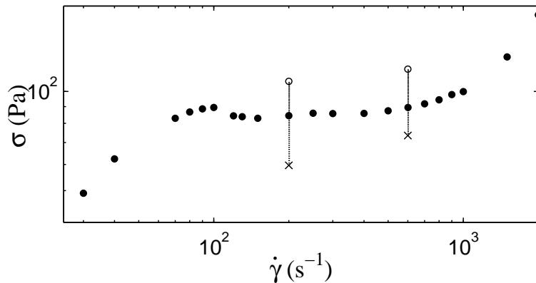
FIG. 3.49 – Zoom sur la courbe d'écoulement  $\sigma(\dot{\gamma})$  obtenue à  $T = 44^\circ\text{C}$  et expériences en saut de cisaillement. Les symboles  $\circ$  et  $\times$  indiquent respectivement le maximum et la dernière valeur de  $\sigma(t)$  après les expériences en saut de cisaillement de 0 à  $186 \text{ s}^{-1}$  et de 0 à  $589 \text{ s}^{-1}$ .
