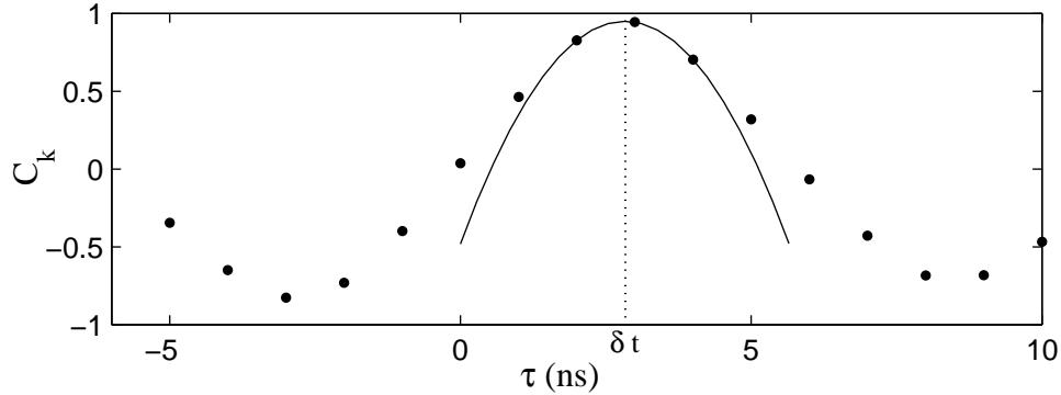
FIG. 2.7 – Fonction de corrélation  $C_k(\tau)$  calculée à partir de l'équation 3.20 appliquée aux deux signaux représentés figure 2.6 (●). La ligne est l'interpolation parabolique  $\tilde{C}_k(\tau)$  et la ligne en pointillés indique la position  $\delta t \simeq 2,8$  ns du maximum de  $\tilde{C}_k$ .
