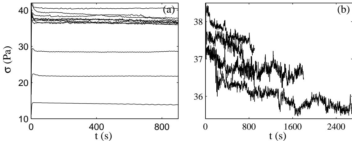
FIG. 3.15 – (a) Réponses temporelles  $\sigma(t)$  à  $T = 41^\circ C$  pendant l'enregistrement d'une courbe d'écoulement. (b) Zoom sur  $\sigma(t)$  pour des cisaillements appliqués dans le plateau de contrainte  $\dot{\gamma} = 38, 66, 76$  et  $118 \text{ s}^{-1}$ .
