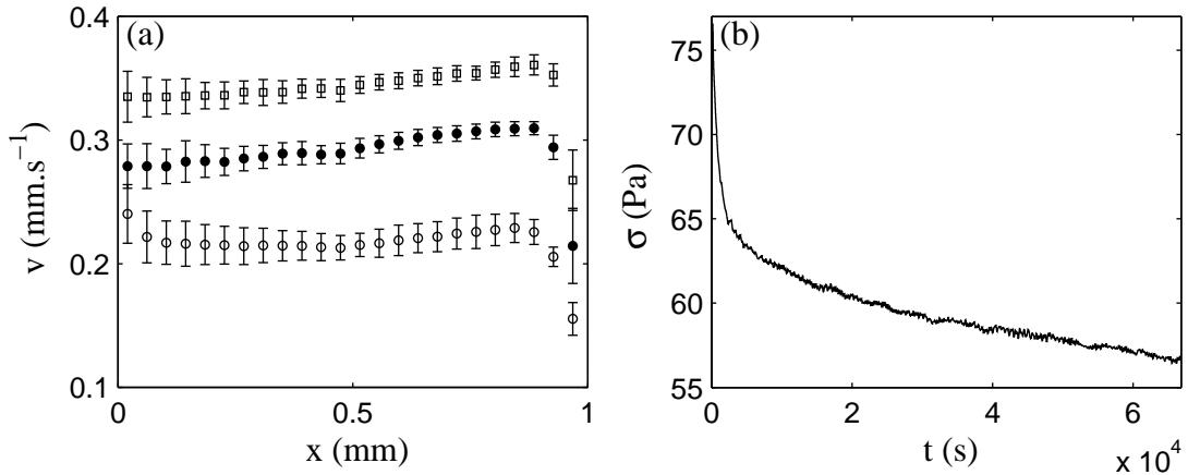
FIG. 4.29 – (a) Évolution de l'écoulement après un saut de cisaillement de 0 à  $0,5 \text{ s}^{-1}$  dans l'émulsion formulée avec 8 % de SDS. Les profils de vitesse sont moyennés sur les intervalles  $t = 0-2000 \text{ s}$  ( $\circ$ ),  $t = 10000-13000 \text{ s}$  ( $\bullet$ ) et  $t = 60000-66700 \text{ s}$  ( $\square$ ). (b) Réponse rhéologique de la contrainte  $\sigma(t)$  enregistrée simultanément aux profils de vitesse.
