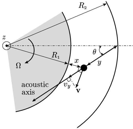
FIG. 2.12 – Conversion de  $v_y(y)$  en  $v(x)$  en géométrie de Couette. L'écoulement est supposé purement orthoradial.  $x$  est la distance radiale au rotor et  $y$  est la distance au stator le long de l'axe acoustique. Figure extraite de la référence [71].
