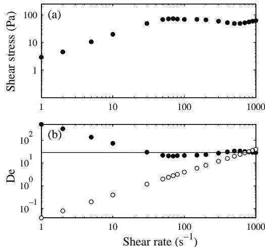
FIG. 3.68 – (a) Courbe d'écoulement  $\sigma(\dot{\gamma})$  enregistrée à  $T = 41^\circ\text{C}$  à cisaillement imposé (800 s par points) et en géométrie cône-plan. Les points sont obtenus en moyennant la réponse en contrainte sur les 100 dernières secondes de chaque pas. (b) Évolution du nombre de Deborah calculé selon les relations 3.30 (○) et 3.31 (●) en fonction du cisaillement  $\dot{\gamma}$  appliqué. La ligne indique le nombre de Deborah critique  $De_c$  donné par l'équation 3.32.
