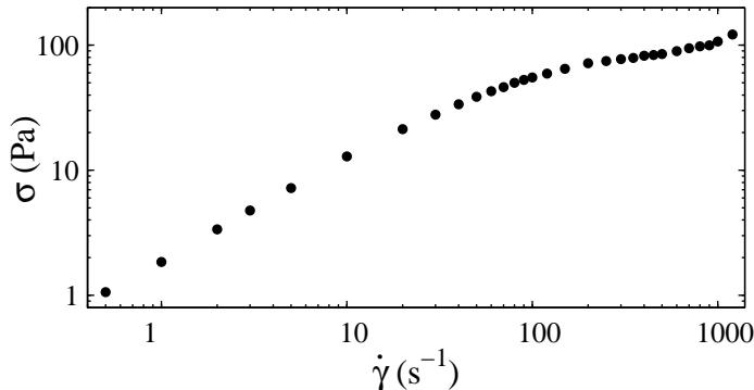
FIG. 3.37 – Courbe d'écoulement  $\sigma(\dot{\gamma})$  enregistrée simultanément à l'acquisition des spectres de diffraction des rayons X à  $T = 41^\circ\text{C}$ . Le taux de cisaillement est imposé (de 300 s à 5000 s par point) et les points sont obtenus en moyennant la contrainte enregistrée sur les 100 dernières secondes de chaque palier.
