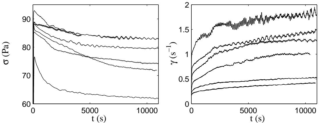
FIG. 4.22 – Réponses rhéologiques enregistrées après des sauts de contrainte et de cisaillement dans l'éulsion formulée avec 8 % de SDS. (a) Réponses temporelles de la contrainte après des sauts de cisaillement de (de bas en haut) 0 à  $0,5 \text{ s}^{-1}$ ,  $1 \text{ s}^{-1}$ ,  $1,2 \text{ s}^{-1}$ ,  $1,5 \text{ s}^{-1}$  et  $2 \text{ s}^{-1}$ . (b) Réponses temporelles du cisaillement après des sauts de contrainte de (de bas en haut) 0 à 60 Pa, 65 Pa, 75 Pa, 80 Pa, 85 Pa et 90 Pa.
