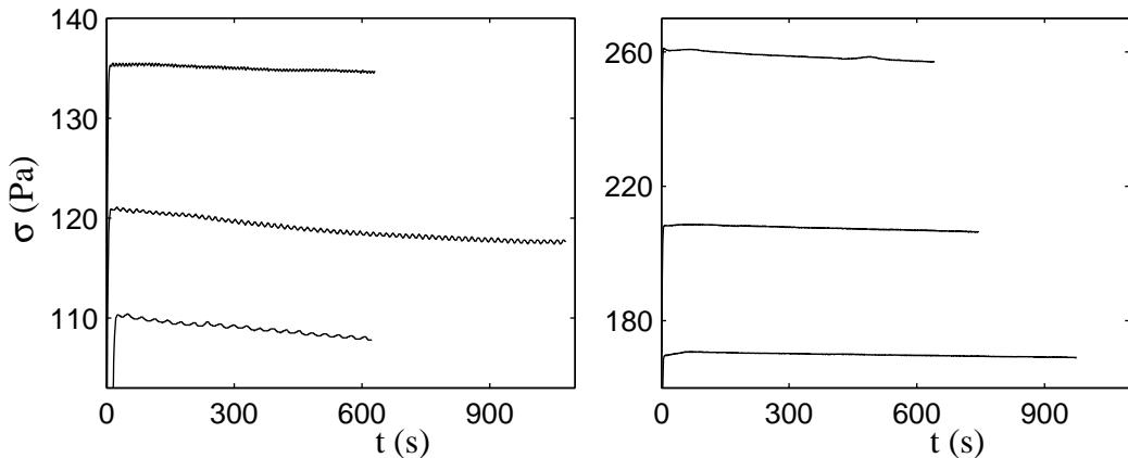
FIG. 4.20 – Réponses temporelles  $\sigma(t)$  enregistrées pendant l'application de paliers de cisaillements croissants sur un même échantillon à  $\dot{\gamma} =$  (a) 5, 10, 20 et (b) 50, 100 et  $200 \text{ s}^{-1}$ .
