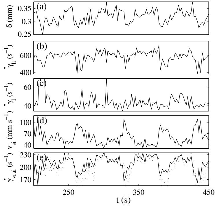
FIG. 3.46 – Description de la dynamique de l’écoulement à  $T = 44^\circ\text{C}$ ,  $\dot{\gamma} = 300 \text{ s}^{-1}$ . Fluctuations (a) de la position de l’interface  $\delta(t)$ , (b) des cisaillements dans les bandes  $\dot{\gamma}_h(t)$  et (c)  $\dot{\gamma}_l(t)$ , (d) de la vitesse de glissement au rotor  $v_{si}(t)$ , (e) du cisaillement vrai  $\dot{\gamma}_{\text{vrai}}(t)$ . Les pointillés sur (e) correspondent au cisaillement vrai calculé à partir de l’équation 3.23.
