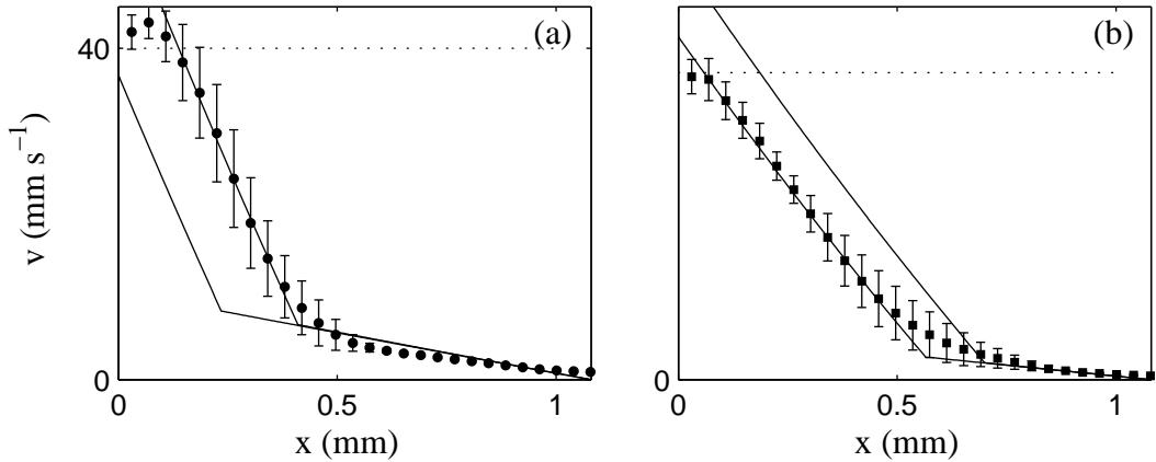
FIG. 3.20 – Profils expérimentaux enregistrés à  $\dot{\gamma} = 37 \text{ s}^{-1}$  (a)  $\dot{\gamma} = 77 \text{ s}^{-1}$  (b). Les lignes en trait plein sont les profils théoriques calculés pour une contrainte globale  $\sigma \pm 1,5\%$ .
