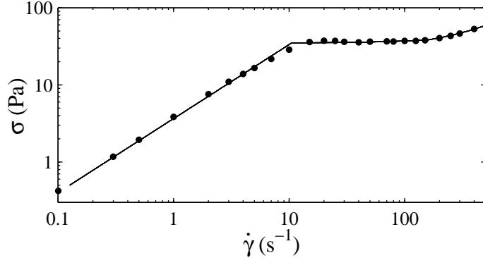
FIG. 3.18 – Courbe d'écoulement expérimentale (●) superposée à la courbe d'écoulement « théorique » (trait plein) pour  $\sigma^* = 34,8 \text{ Pa}$ .
