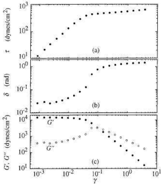
FIG. 4.1 – Rhéologie linéaire d'une émulsion concentrée à  $\phi = 0,7$ , avec un rayon des gouttelettes de  $0,53 \mu\text{m}$ . La fréquence appliquée esr  $\omega = 1 \text{ rad.s}^{-1}$ . (a) Amplitude de la contrainte  $\sigma$ , (b) déphasage  $\delta$  et (c) modules élastique  $G'$  ( $\bullet$ ) et de perte  $G''$  ( $\circ$ ) en fonction de l'amplitude de la déformation. Figure extraite de la référence [75].
