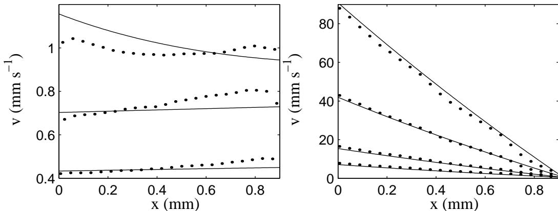
FIG. 4.44 – Comparaison entre les profils de vitesse théoriques (trait plein) obtenus pour un fluide décrit par l'équation d'Herschel-Bulkley avec  $\sigma_0 = 53,2 \text{ Pa}$ ,  $n = 0,41$  et  $A = 14,5 \text{ Pa s}^{0,41}$  et les profils de vitesse expérimentaux ( $\bullet$ ) enregistrés à  $\dot{\gamma} = 1, 1,5, 2 \text{ s}^{-1}$  (a) et  $10, 20, 50$  et  $100 \text{ s}^{-1}$ .
