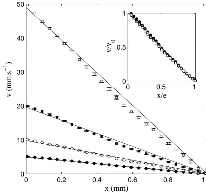
FIG. 2.13 – Profils de vitesse  $v(x)$  obtenus à partir des équations 2.6 et 2.7 avec  $c_0 = 1530 \text{ mm s}^{-1}$ ,  $t_s = 13,55 \mu\text{s}$  et  $\theta = 11,7^\circ$ . Les lignes continues sont les profils newtoniens calculés à partir de l'équation 2.9 pour les différentes vitesses du rotor  $v_0$  appliquées. L'insert présente les profils normalisées  $v/v_0$  vs.  $x/e$ .
