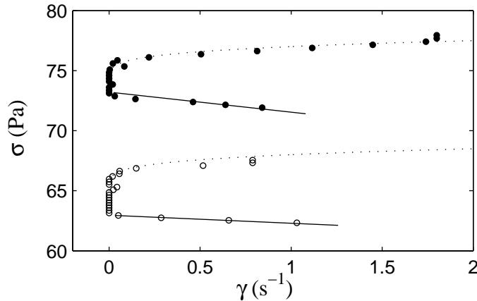
FIG. 4.28 – Courbe d'écoulement locale  $\sigma(x) = f(\dot{\gamma}(x))$  obtenue à partir des profils de vitesse enregistrés après des sauts de contrainte de 0 à 65 Pa (○) et 75 Pa (●). Les lignes en pointillés sont données par  $\sigma = \sigma_0 + A\dot{\gamma}^n$  avec  $A = 3 \text{ Pa}\cdot\text{s}^{0,22}$ ,  $n = 0,22$  et respectivement  $\sigma_0 = 65$  et 74 Pa. Les lignes en trait plein sont des guides pour les yeux.
