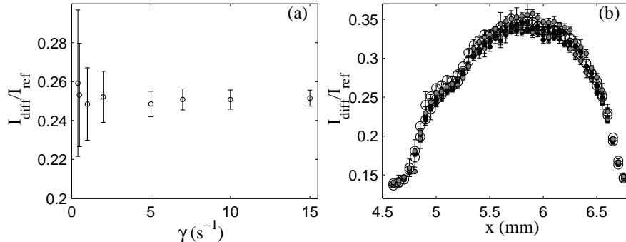
FIG. 4.49 – (a) Intensité de la lumière diffusée au milieu de l'entrefer  $I_{diff}$  rapportée à l'intensité de référence  $I_{ref}$  en fonction du cisaillement appliqué  $\dot{\gamma}$ . (b) Intensité de la lumière diffusée au milieu de l'entrefer  $I_{diff}$  rapportée à l'intensité de référence  $I_{ref}$  en fonction de la position dans l'entrefer. Six profils de concentration enregistrés à 5000 s d'intervalle sont représentés.
