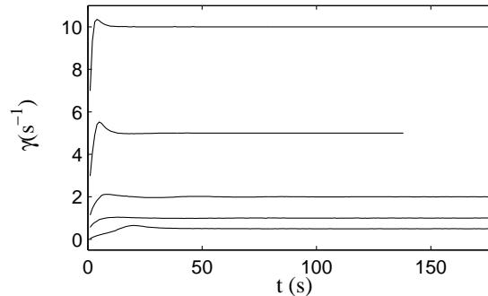
FIG. 3.9 – Paliers de cisaillement appliqués à  $\dot{\gamma} = 0, 5, 1, 2, 5$  et  $10\text{ s}^{-1}$ .
