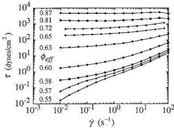
FIG. 4.3 – Courbes d’écoulement  $\sigma = f(\dot{\gamma})$  enregistrées dans des émulsions concentrées pour un rayon des gouttelettes de  $0,25 \mu\text{m}$  et une fraction volumique en phase dispersée  $\phi$  variant entre 0,55 et 0,88.
