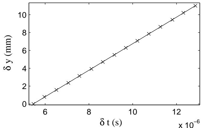
FIG. 2.10 – Position du récepteur  $\delta y$  en fonction du délai de réception du impulsion  $\delta t$ . La distance entre l'émetteur et le récepteur à  $\delta y=0$  est d'environ 10 mm. La pente de la droite obtenue conduit à une détermiation de la vitesse du son dans le milieu (ici, une suspension de latex à 46°C). On trouve ici  $c_0 = 1530 \text{ mm.s}^{-1}$ .
