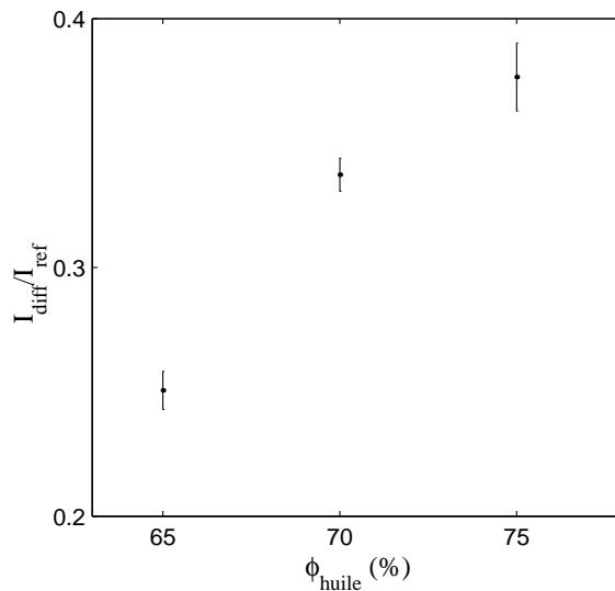
FIG. 4.48 – Intensité de la lumière diffusée au milieu de l'entrefer  $I_{\text{diff}}$  rapportée à l'intensité de référence  $I_{\text{ref}}$  en fonction de la fraction massique de l'émulsion en huile.
