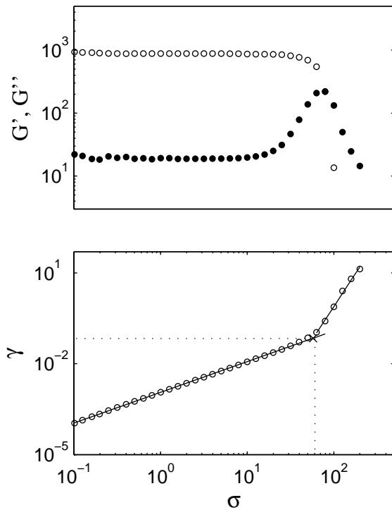
FIG. 4.19 – Rhéologie linéaire en balayage de contrainte enregistrée dans l’émulsion concentrée huile de Ricin dans eau stabilisée par 8% de SDS. La fréquence appliquée est de 1 Hz.
