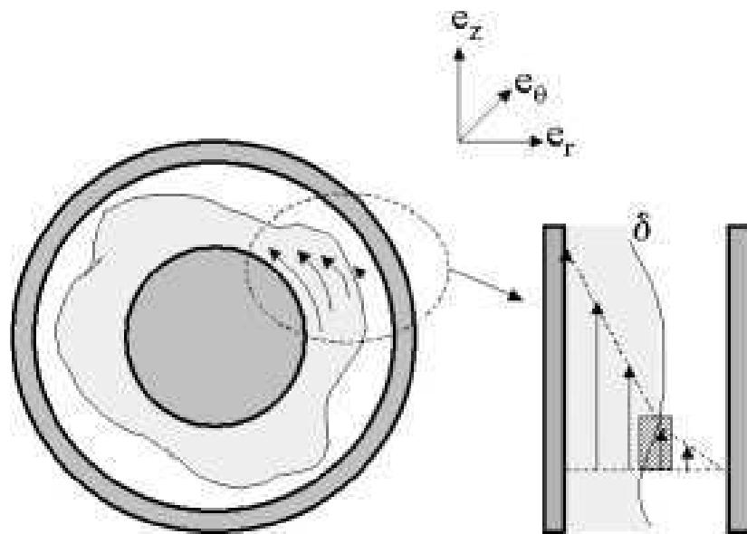
FIG. 3.70 – Représentation schématique d'une répartition inhomogène de l'interface entre les bandes dans la direction orthoradiale : la zone grisée indique la localisation de la zone fluide dans la cellule. Le rectangle hachuré sur le schéma de droite indique la zone de fluide « sondée » pendant l'enregistrement d'un profil de vitesse.
