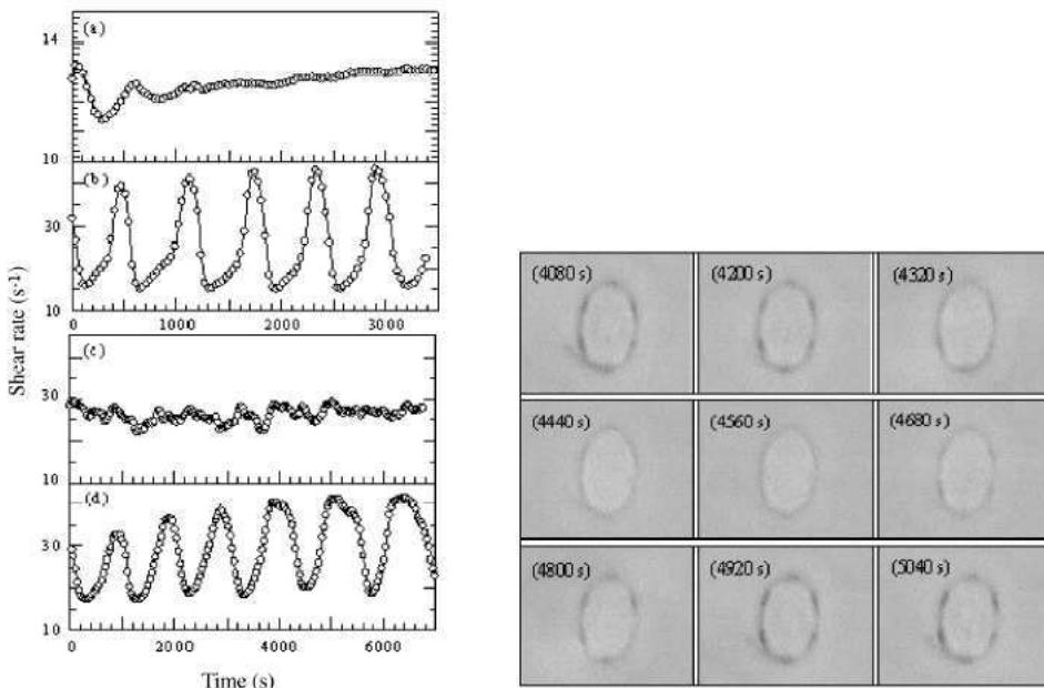
FIG. 1.5 – Oscillations de viscosité dans une phase lamellaire SDS/Octanol/NaCl/H<sub>2</sub>O sous cisaillement. Les spectres de diffraction représentés à droite de la figure sont enregistrés simultanément aux oscillations représentées sur la figure(d) : le facteur de structure oscille en phase avec le cisaillement. La figure est tirée de la référence [114].
