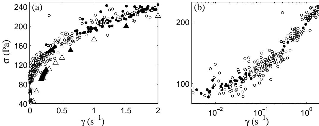
FIG. 4.11 – (a) Courbe d'écoulement locale  $\sigma(x) = f(\dot{\gamma}(x))$  obtenue à partir des données enregistrées à contrainte imposée (●) et à cisaillement imposé (○). Les symboles ▲ et △ correspondent respectivement aux données rhéologiques globales enregistrées à contrainte et à cisaillement imposés. (b) La même courbe d'écoulement locale  $\sigma(x) = f(\dot{\gamma}(x))$  en représentation logarithmique.
