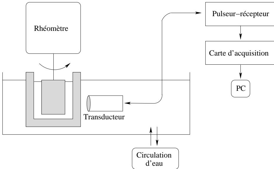
FIG. 2.3 – Représentation schématique du montage expérimental de vélocimétrie ultrasônore.
