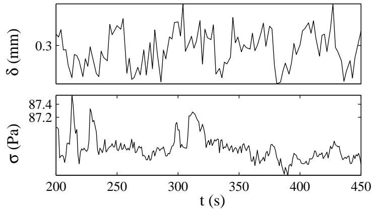
FIG. 3.47 – Fluctuations de la position de l’interface  $\delta(t)$  et de la contrainte globale  $\sigma(t)$  à  $\dot{\gamma} = 300 \text{ s}^{-1}$ .
