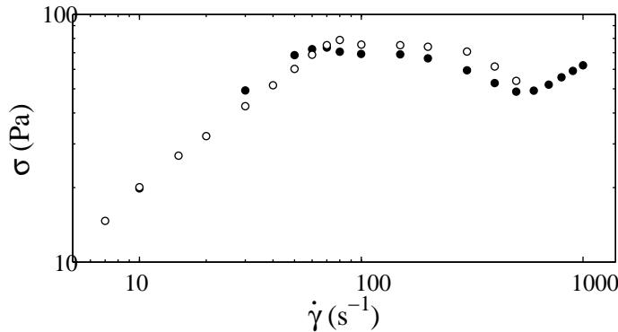
FIG. 3.7 – Courbes d’écoulement enregistrées à  $T = 41^\circ\text{C}$  en géométrie cône-plan sur une solution de micelles géantes « pure » (●) et sur une solution de micelles géantes ensemencée avec 1% en masse de diffuseurs (○).
