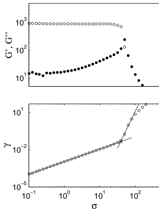
FIG. 4.36 – Rhéologie linéaire en balayage de contrainte enregistrée dans l’émulsion concentrée huile de Ricin dans eau stabilisée par 1% de SdS . La fréquence appliquée est de 1 Hz. (a) Modules de recouvrement  $G'$  et de perte  $G''$  en fonction de la contrainte. (b) Déformation enregistrée en fonction de la contrainte. Cette représentation permet de repérer facilement la contrainte seuil  $\sigma_c = 39$  Pa correspondant à la rupture de pente.
