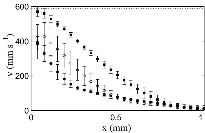
FIG. 3.57 – Dynamique lente après un saut de cisaillement de 0 à  $589 \text{ s}^{-1}$  à  $T = 45^\circ\text{C}$ . Profils de vitesse  $\langle v(x) \rangle$  moyennés sur  $t = 500\text{--}561$  (●),  $7000\text{--}7062$  (○), et  $14000\text{--}14152$  s (■). Les barres d'erreur sont les déviations standard des vitesses. La ligne en pointillés indique la vitesse du rotor  $v_0 = 588 \text{ mm s}^{-1}$ .
