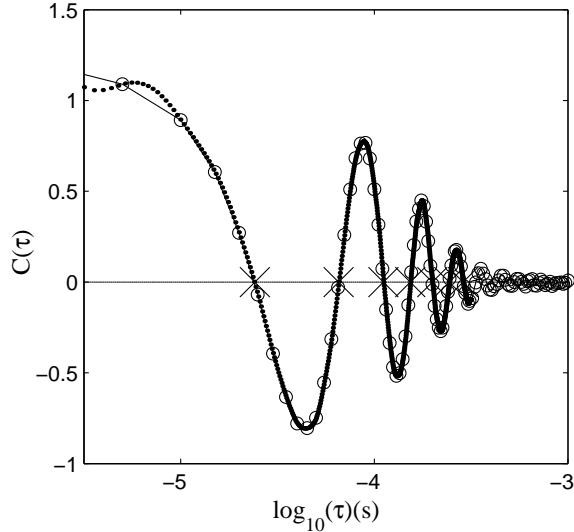
FIG. 2.2 – Fonction de corrélation hétérodyne obtenue sur une suspension de latex cisaillée à  $\dot{\gamma} = 10 \text{ s}^{-1}$ . Les cercles ( $\circ$ ) sont les données expérimentales calculées par le corrélateur. Les pointillés représentent l'interpolation des données expérimentales sur une gamme de temps échantillonnée plus précisément. Les annulations de la fonction d'interpolation (indiquées par des croix ( $\times$ )) permettent de définir la fréquence des oscillations.
