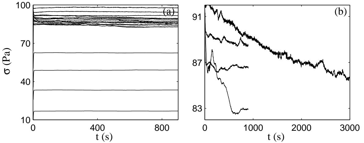
FIG. 3.39 – (a) Réponses temporelles  $\sigma(t)$  à  $T = 44^\circ\text{C}$  pendant l'enregistrement d'une courbe d'écoulement. (b) Zoom sur les réponses temporelles pour des cisaillements appliqués dans le plateau (respectivement de haut en bas)  $\dot{\gamma} = 70, 80, 90$  et  $120 \text{ s}^{-1}$ .
