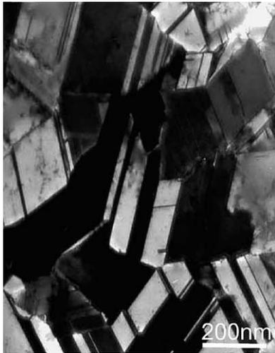
**Figure 3.10 :** microstructure du cuivre nanostructuré élaboré par électrodéposition pulsé [Lu '05]. Cette technique d'élaboration permet d'introduire une densité de macles variable dans les grains ultrafins. La taille des grains est de 500 nm et la largeur des macles est égale à 90 nm.
