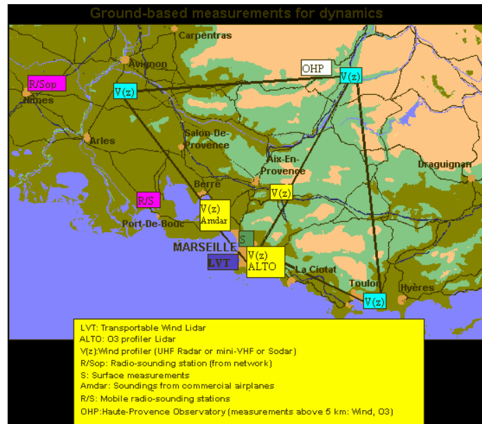
Figure 19 : Instrumentation mis en œuvre pour suivre la dynamique locale pendant la campagne ESCOMPTE dans les alentours de Marseille pendant l'été 2001.
