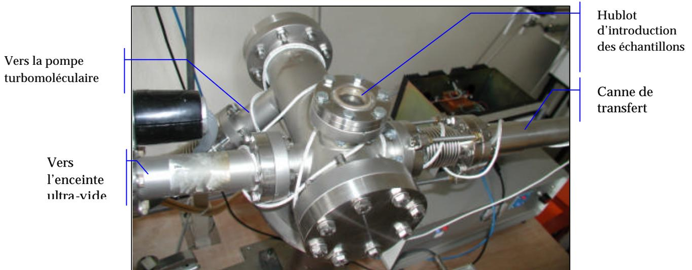
*Fig. 17 : photographie de la chambre d'introduction rapide d'échantillons*
