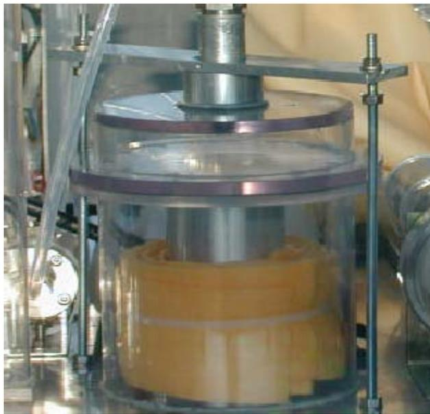
Figure 7-16: La cellule rotative : première ébauche d'une cellule rhéomètre.
