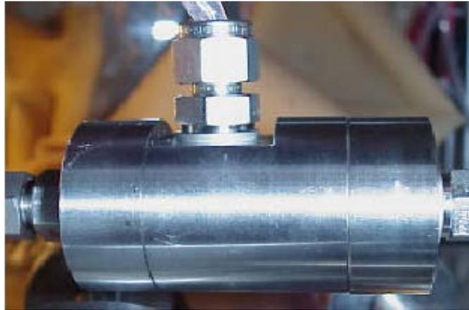
**Figure 7-13 : Le mélangeur turbulent.**
