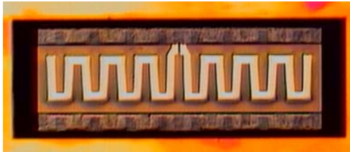
Figure 4.20 : Photographie d'une antenne dipôle suspendue sur une membrane rectangulaire en BCB obtenue par une gravure KOH: vue de dessous
