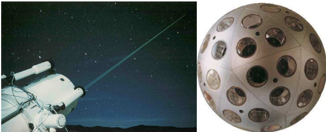
FIG. 1.2 – La technique SLR - A droite : tir sur un satellite à la station de Grasse, France (source : OCA). A gauche : le satellite Stella du CNES (source : CNES)
