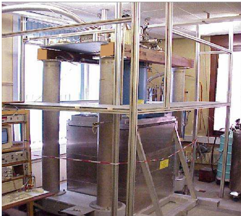
FIG. 4.1 – Dispositif expérimental pour les expériences de MACHe3 contenant un cryostat à désaimantation nucléaire entouré du château de plomb de 4 tonnes d'une épaisseur de 8 cm permettant un blindage de couverture géométrique \sim 80\% .
