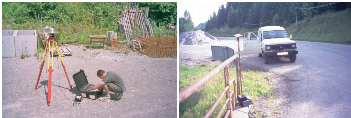
Figure 2-7 Mesures DGPS (Differential Global Positioning System) sur le secteur du Manival. A gauche, la station "permanente" et à droite, le récepteur mobile (Clichés S.V-C.)
