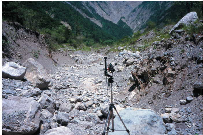
Figure 2-13 Matériel de mesure topographique utilisé dans le chenal torrentiel : télémètre laser Impulse et boussole électronique Mapstar sur trépied (Cliché S.V.-C.)
