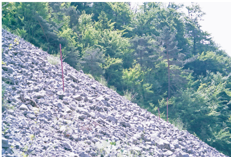
Figure 3-31 Les piquets rouges de 1,5 m qui ont été plantés à des profondeurs de 50 cm et de 1 m dans le tablier d'éboulis, n'ont pas été déplacés au cours de la période d'observation (1999-2003) (Cliché S.V-C.)
