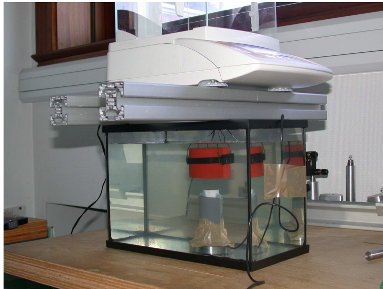
FIG. 2.2 – Photographie du montage de la balance.
