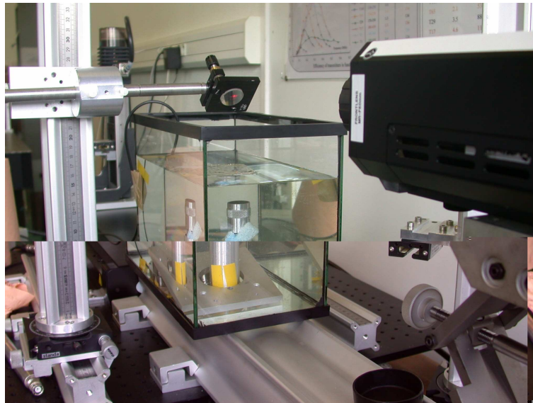
FIG. 2.6 – Photographie du montage de l'interféromètre laser.
