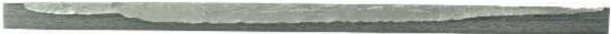
FIG. 3.30 – Coupe longitudinale d’une ligne de fusion A-TIG avec un dépôt de flux activant en configuration “Vé”
