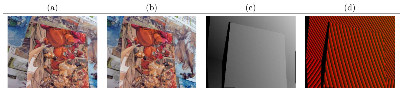
FIG. 2.11 – Couple stéréoscopique d'images réelles proposé, « livres » – Les images gauche (a) et droite (b) sont présentées ainsi que la carte de disparités (c) et la carte des iso-disparités (d).
