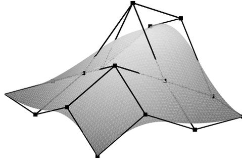
FIG. 3.1 – Patch B-spline et son maillage de contrôle
