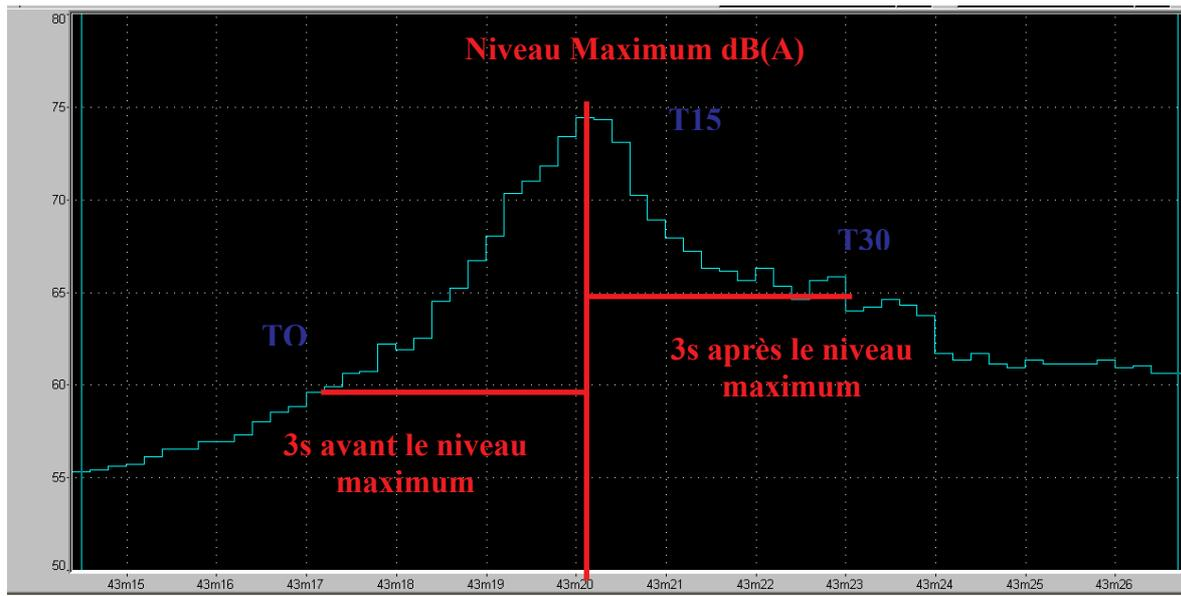
**Figure 67** : Courbe de  $L_{Aeq,200ms}$  d'un passage de véhicule avec indication de la période sur laquelle sont calculés les attributs, soit 3 s avant et après le niveau maximum.
