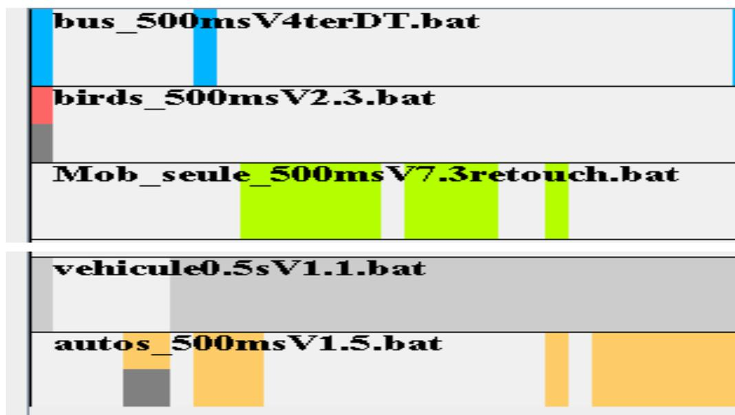
**Figure 96** : Détections effectuées sur le stimulus n°2 par pas de 0.5 s. Chaque ligne correspond au résultat du calcul d'un descripteur sur les 15 s de la séquence. La présence d'une couleur est le signe d'une détection positive.
