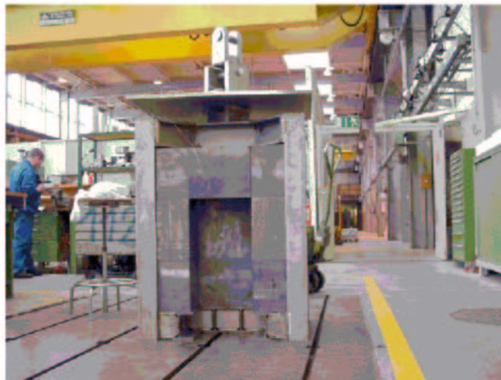
FIG. 3.2 – Photo de l'assemblage de blocs de plomb de la cible de spallation.
