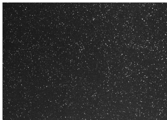
FIG. 2.15 – Exemple d'une image prise par la caméra rapide P.I.V.
