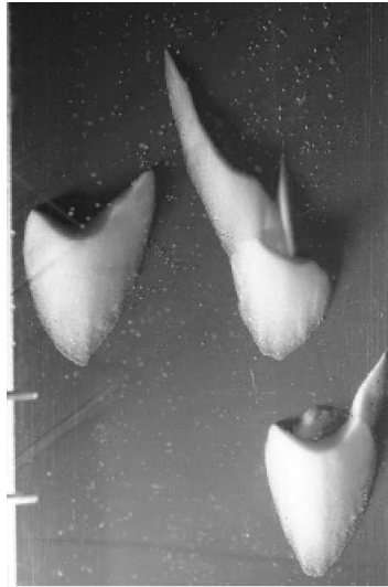
FIG. 3.25 – Découpage de la barre transverse en barchanes, après 15 min d'érosion. L'écoulement est du bas vers le haut.
