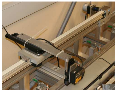
FIG. 2.2 – Rails de translation et télémètre. En haut à droite, le moteur du rail principal.
