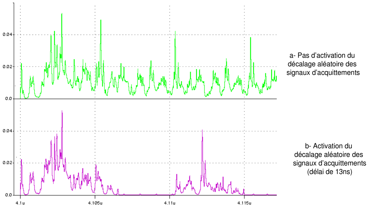
Figure 7.12: Profils de courant des premières itérations du DES avec et sans activation du décalage des signaux d'acquittements
