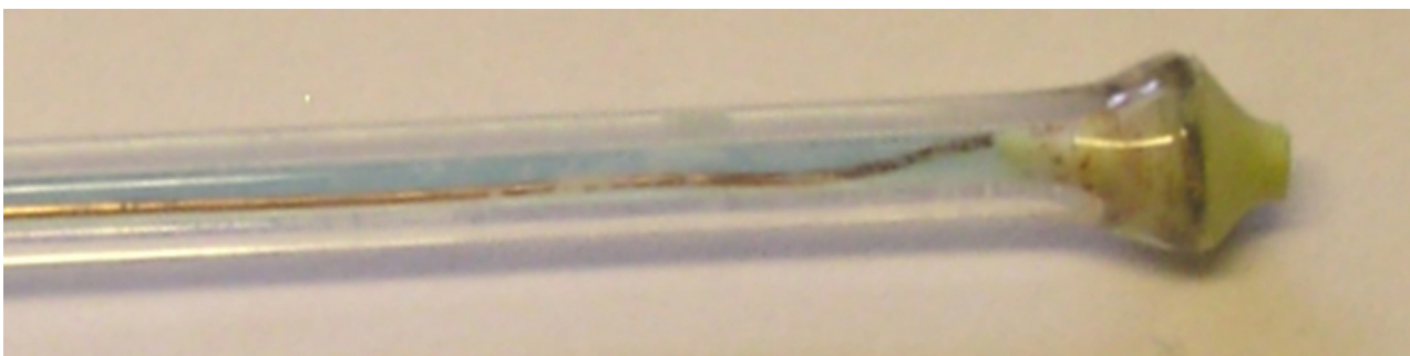
Figure 2.11. Détail des électrodes: bouchon poreux. La céramique poreuse est insérée dans l'extrémité du capillaire, préalablement évasée, puis collée avec de la résine époxy et sectionnée à 8 mm. Ce poreux assure le contact électrolytique entre le milieu extérieur et la solution de sulfate de cuivre (bleu), dans laquelle baigne le fil de cuivre de mesure du potentiel.
