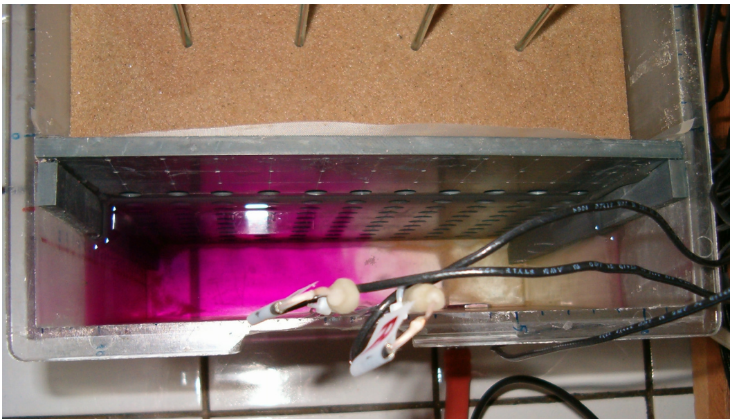
Figure 5.11. Réaction \text{KMnO}_4\text{-FeCl}_2 : sortie des réactifs, vue de dessus. Vue de dessus du réservoir aval peu après l'arrivée des réactifs. Violet : permanganate de potassium; incolor : chlorure de fer II. La zone de contact est localisée suivant le plan médian vertical longitudinal.
