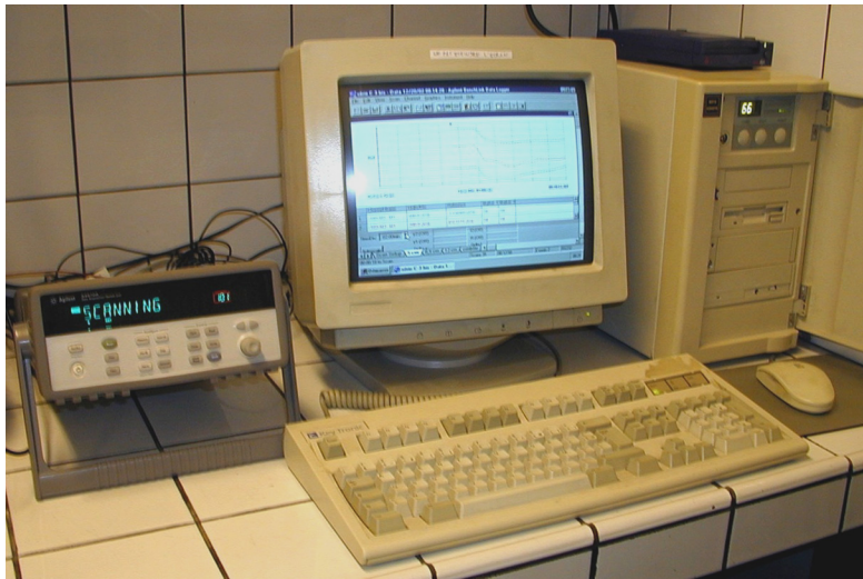
Figure 2.15. Datalogger et PC. Les signaux mesurés par les électrodes sont numérisés par la centrale Agilent 34970A (à gauche) équipée de deux multiplexeurs Agilent 34901A, puis transmis par câble RS-232 à un PC, qui les affiche et les enregistre.
