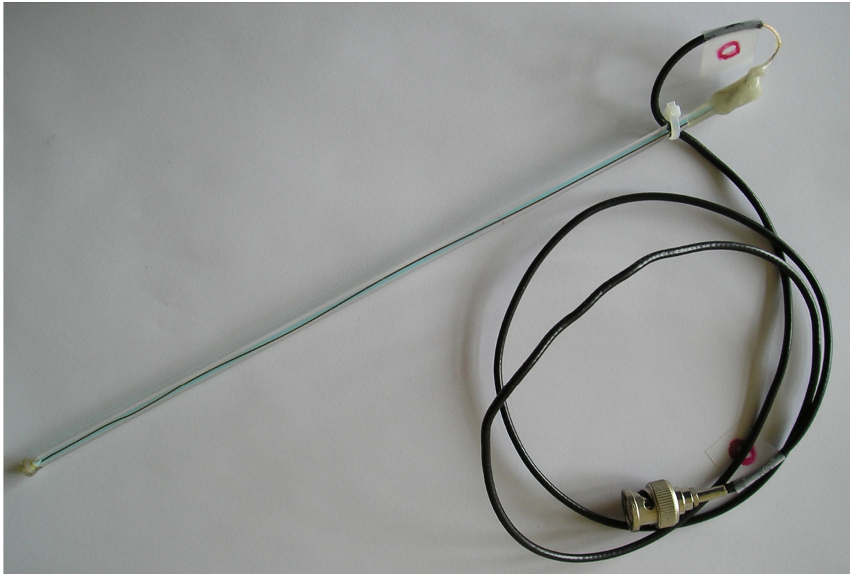
Figure 2.14. Electrode. Un fil de cuivre baigne dans une solution saturée de sulfate de cuivre emplissant un capillaire de verre. Le contact avec le milieu extérieur est assuré par une céramique poreuse. A l'autre extrémité, hermétiquement scellée, le fil est soudé au conducteur d'un câble coaxial, dont le blindage est laissé à l'air libre, et terminé par une prise BNC mâle.
