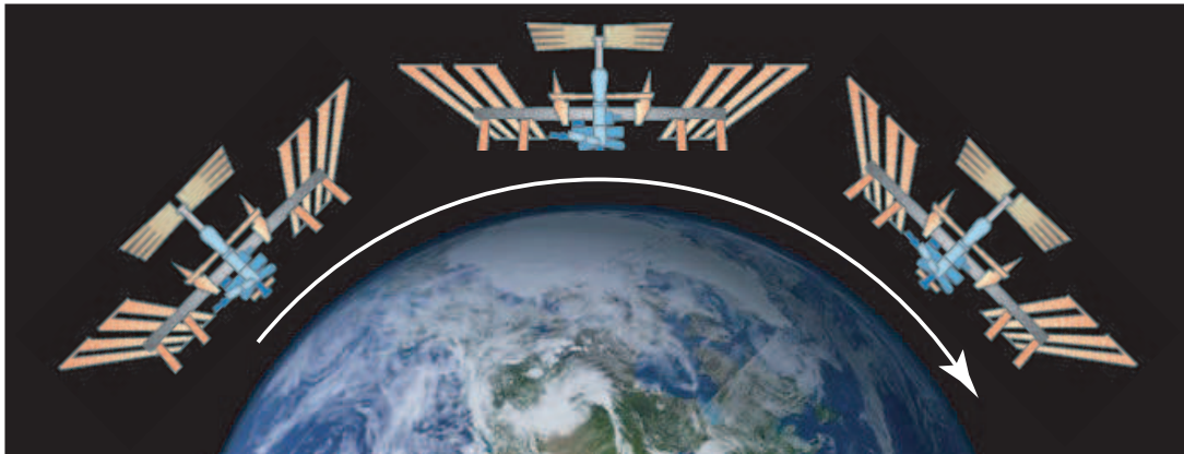
Fig. 7.1: La Station spatiale tourne de manière à présenter toujours la même face vers l'espace. AMS est du côté opposé à la Terre et pointe en permanence vers l'espace. Image J. Bolmont.
