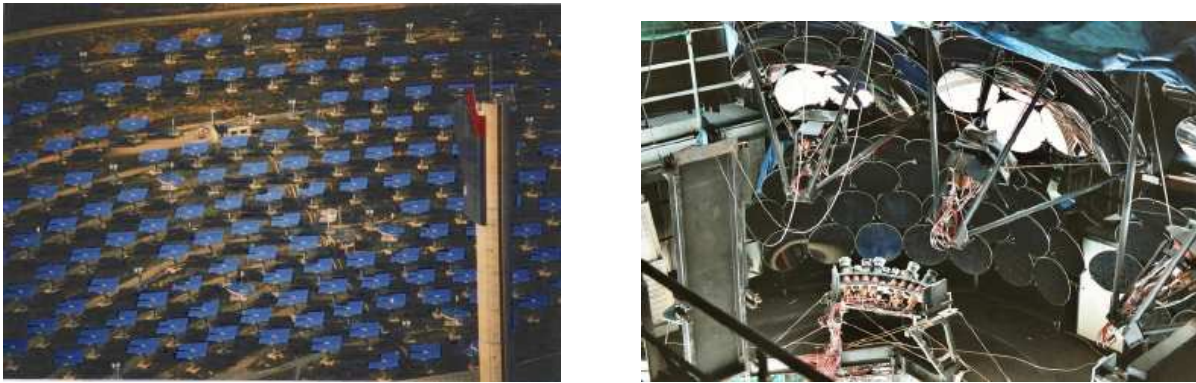
Fig. 1.14: Le détecteur CELESTE, sur le site de l'ancienne centrale solaire THEMIS dans les Pyrénées Orientales. Les miroirs visibles sur la photo renvoient la lumière des Čerenkov des gerbes vers la tour située à droite. Image EDF. À droite, dans la tour, les miroirs secondaires et en bas, les photomultiplicateurs. Un photomultiplicateur voit un miroir. Image R. Britto.
