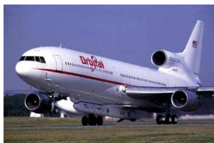
Fig. 4.1: Un lancement de la fusée Pegasus. Le lanceur est initialement accroché à un avion qui l'emporte jusqu'à une altitude d'environ 12000 m, avant de le larguer. Le reste de l'ascension s'effectue avec un moteur fusée. La figure de droite illustre le lancement de DART, un satellite destiné à expérimenter les rendez-vous spatiaux automatiques.
