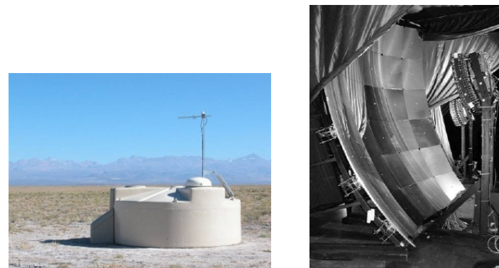
Fig. 1.15: Un des 1600 détecteurs d'Auger installé dans la Pampa Argentine. Il s'agit en fait d'une cuve contenant 12 t d'eau et équipée de trois photomultiplicateurs. L'image de droite montre un télescope à fluorescence. D'après [33].
