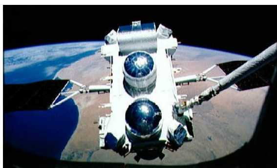
Fig. 1.4: Le déploiement du satellite CGRO vu depuis la navette Atlantis le 7 avril 1991. L'élément circulaire du bas protège le détecteur EGRET. Celui du milieu couvre COMPTEL. En haut se trouve le détecteur OSSE. Un peu en dessous d'EGRET, à gauche et à droite, on distingue deux des huit éléments de BATSE. Image NASA.
