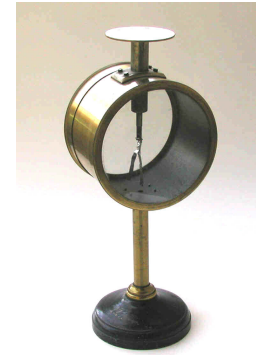
Fig. 1.1: Un électroscope à feuille d'or (vers 1900). L'appareil est constitué de deux feuilles métalliques très légères (ici de la feuille d'or). On commence par charger électriquement ces feuilles métalliques, qui s'écartent l'une de l'autre. Lorsqu'une particule chargée passe à proximité des feuilles, elle ionise l'air environnant et une partie de la charge électrique des feuilles est transmise à l'air. Ainsi, en mesurant le temps que mettent les feuilles métalliques pour se rejoindre, on peut avoir une idée du flux de particules ayant provoqué une ionisation dans l'air. Image Oak Ridge Associated Universities.
