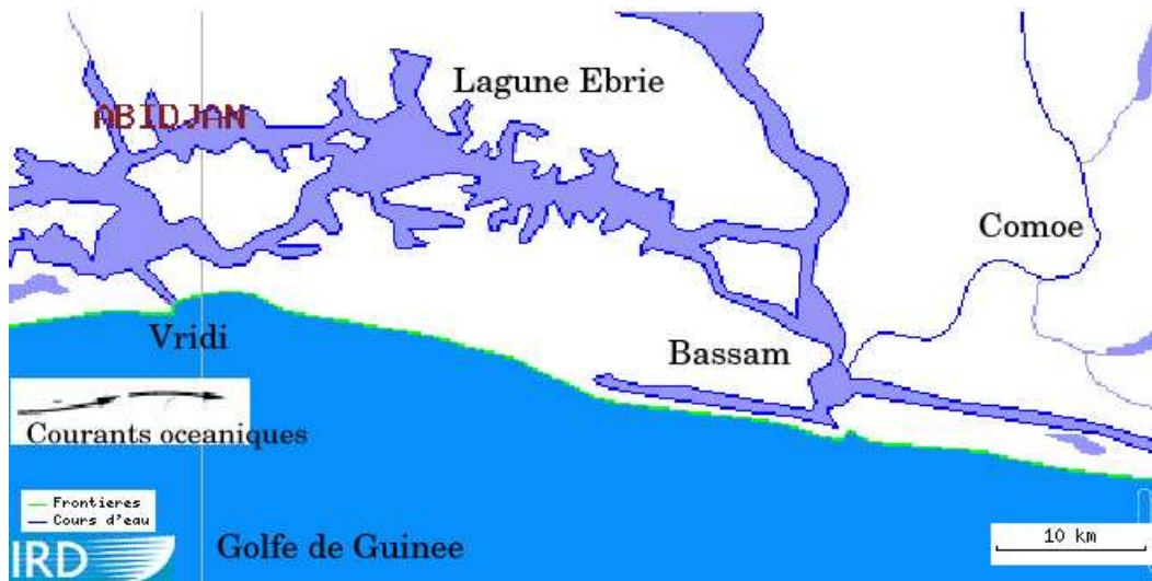
FIG. 1.1 – Système lagunaire dans la région d'Abidjan en Côte d'Ivoire, débouchant sur l'océan atlantique dans le Golfe de Guinée avec les courants transport des sables marins d'ouest en est (source : http://aochycos.ird.ne/ ).
