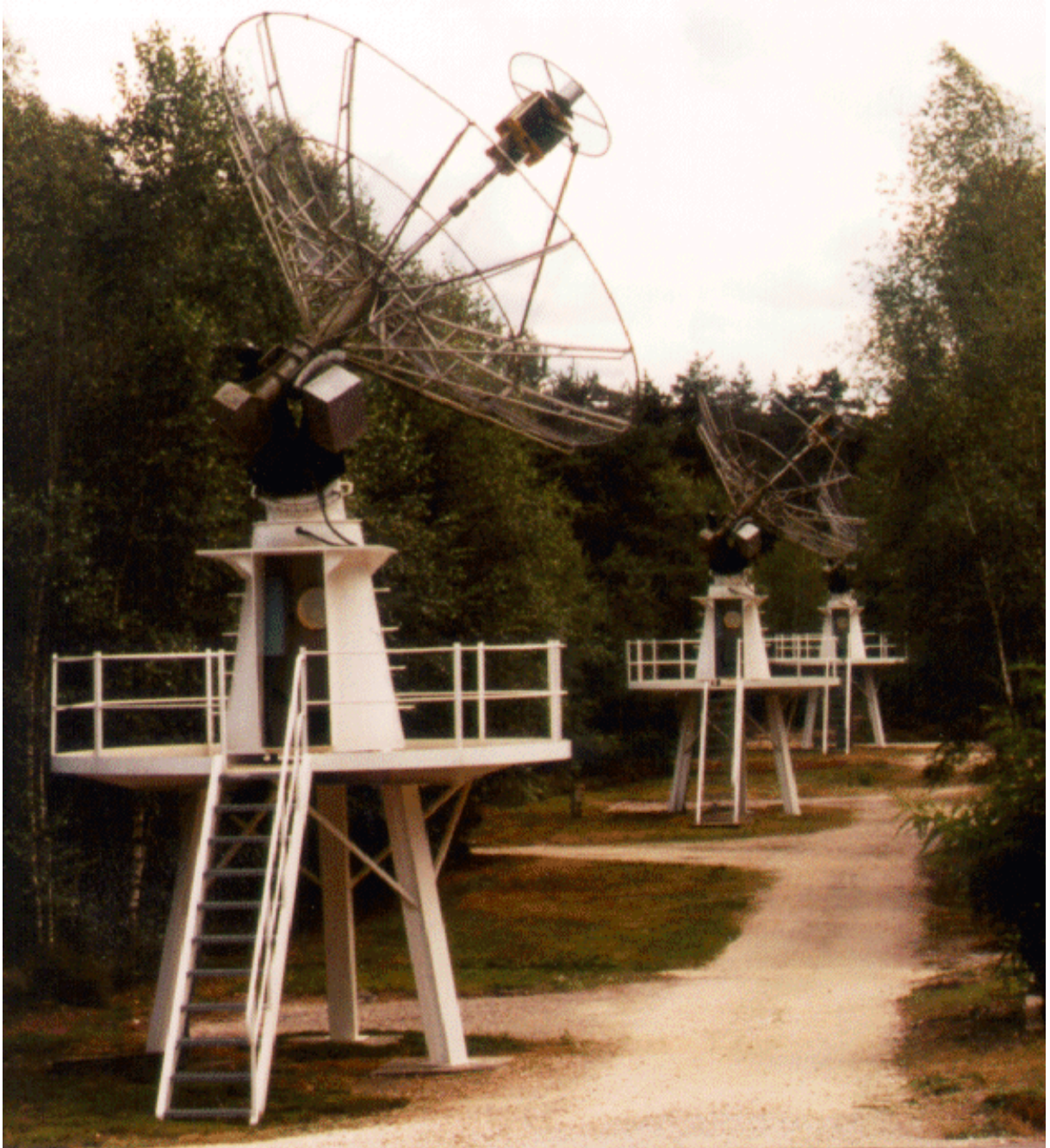
FIG. 1.6 – Antennes du réseau Nord Sud du radiohéliographe, la déclivité du sol est compensée par les plate-formes situées sous les montures équatoriales.
