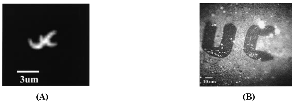
Figure II.13 Utilisation de la SECM pour: (A) l'écriture de motifs de biotine sur un substrat de carbone, (B) le détachement de régions localisées de complexe biotinelavidine sur la surface 86 .
