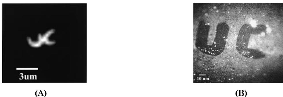
**Figure II.13** Utilisation de la SECM pour : (A) l'écriture de motifs de biotine sur un substrat de carbone, (B) le détachement de régions localisées de complexe biotinelavidine sur la surface<sup>86</sup>.
