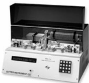
Figure 2 : Etireuse de capillaire SUTTER Instrument P-97.
