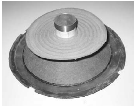
FIG. 3.14 – Diaphragme + suspension périphérique + spider + bobine électromagnétique - Modèle Samy Speaker
