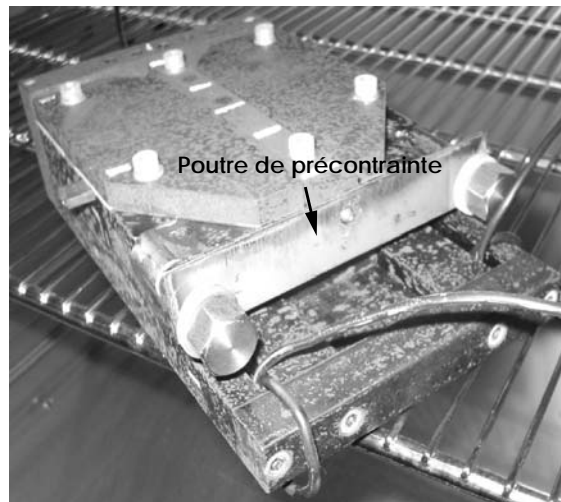
FIG. 2.4 – Poutre de précontrainte montée sur le banc
