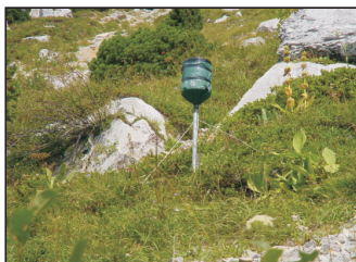
Pluviographe à augets basculeurs.
