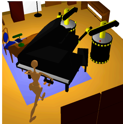
FIG. 1.5 – Une version “moderne” du problème du déménageur de piano. Le système mis en œuvre incorpore, en plus du piano, un personnage virtuel et deux manipulateurs mobiles. Ce système à nombreux degrés de liberté doit naviguer dans un environnement encombré en intégrant en plus des contraintes de fermeture cinématique (d’après [Esteves 06]).
