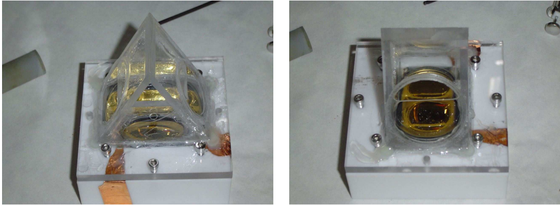
FIG. 12.7: Photos de la cellule expérimentale pour les transitions de mouillage. Échelle : la cellule fait 8 cm de côté.
