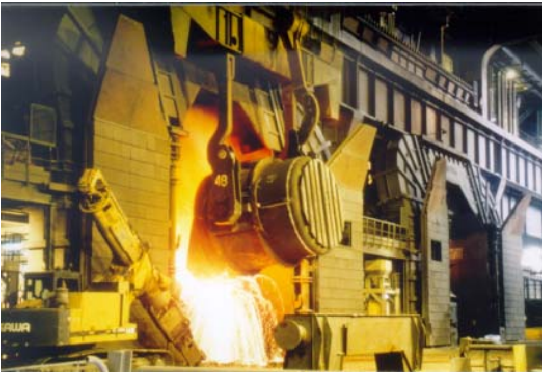
Figure 75.b : Versement de la fonte dans un convertisseur de désulfuration.
