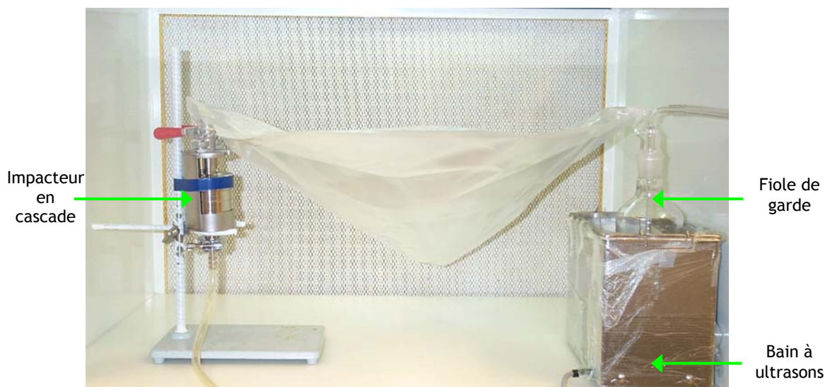
Figure 52 : Dispositif de mise en suspension des poudres de particules modèles, sous hotte à flux laminaire classe 100.
