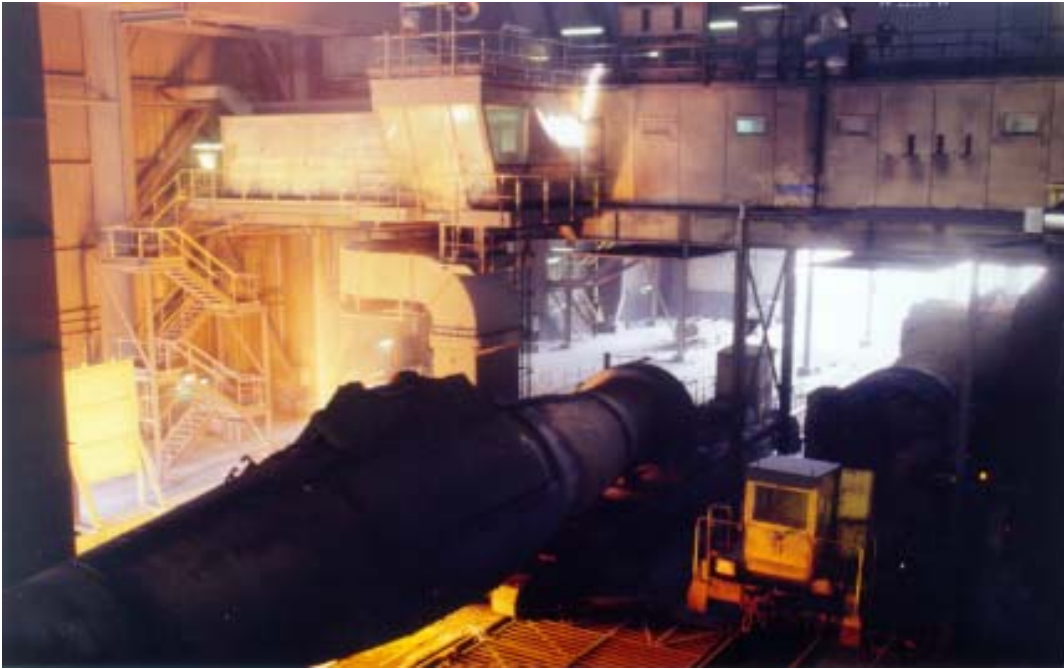
Figure 75.a : Vue générale du hall de versée (remplissage d'un wagon-tonneau).
