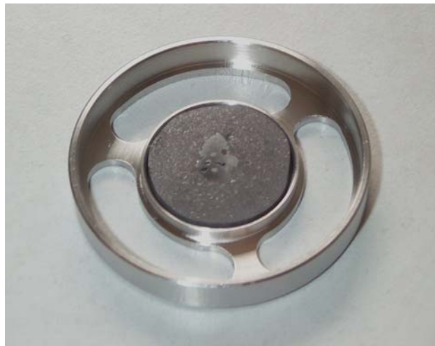
Figure 39 : Etage d'impaction conçu pour le montage d'une section polie de bore (imprégnée ici dans de la résine conductrice enrichie en paillettes de carbone).
