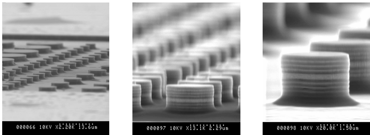
Figure 3 : Images SEM obtenues sur l'échantillon MOR5208 avec le procédé Spyros05 (SiCl 4 : 8 sccm; O 2 : 0 sccm; Puissance RF : 14 W; Pression 2.6 mbars; Tension d'autopolarisation de l'ordre de 220 V). Le masque de gravure est formé de 300 Å de Ni.
