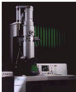
Figure 84 : Microscope électronique à transmission CM12, Philips utilisé pour l'observation des grilles. La source d'électrons est une cathode en hexaborure de lanthane (LaB 6 ). La tension de travail est 120 kV.
